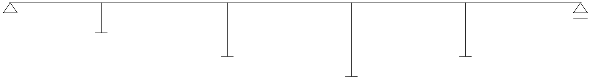
Figur 4: Statisk system for Karlsplassen bru.
