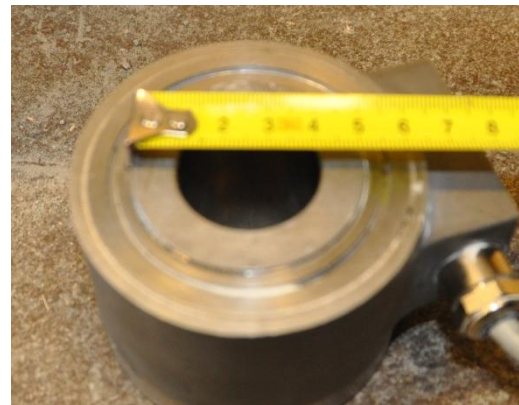
(b) Utstikkende anleggsflate på lastcelle
