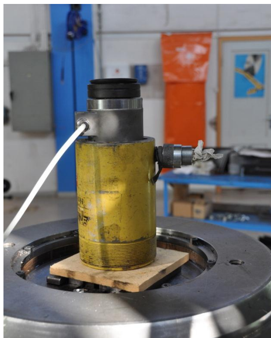
Figur 11.7: Forsøk av feilaktig montering av jekk
