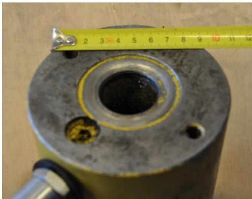
(a) Fordypning i underside av jekk
