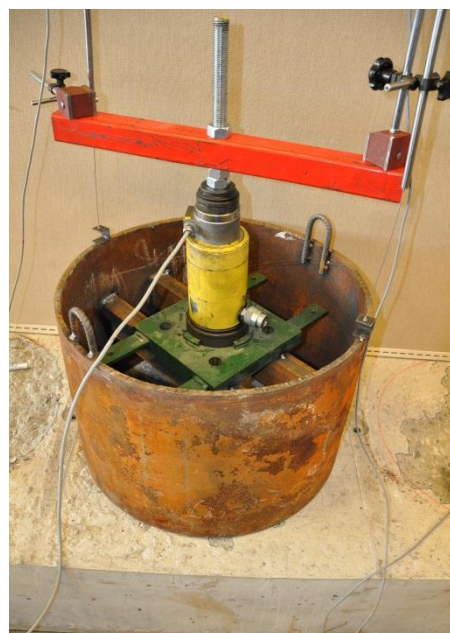
Figur 11.4: Forsøksoppsett uttrekkforsøk av bolter
