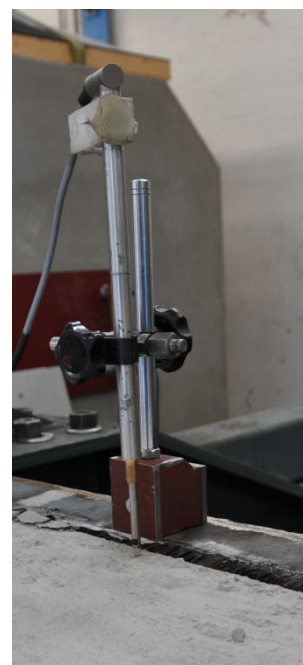
Figur 10.9: Forskyvningsmåler topp betongvegg
