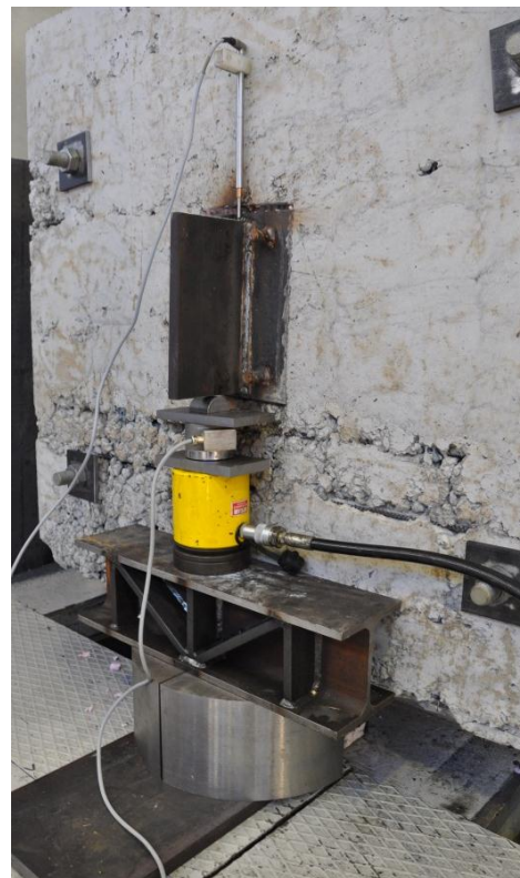
Figur 10.8: Forsøksoppsett ståldetalj uten fiber
