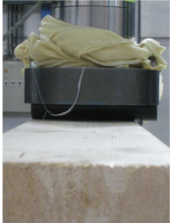
Figur 7: Punktlasten plassert mot høyre, for å komme i kontakt med forskyvningsmåler.
