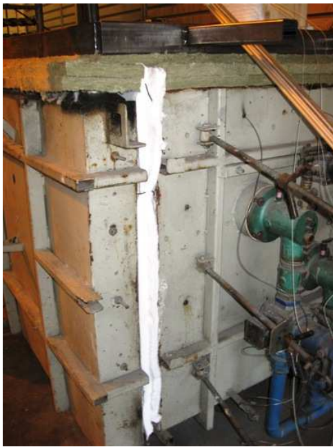
Figur 5.3: Bildet viser overgangen mellom den fastmonterte delen og den flyttbare vegg i ovnen. Foto: Privat.
