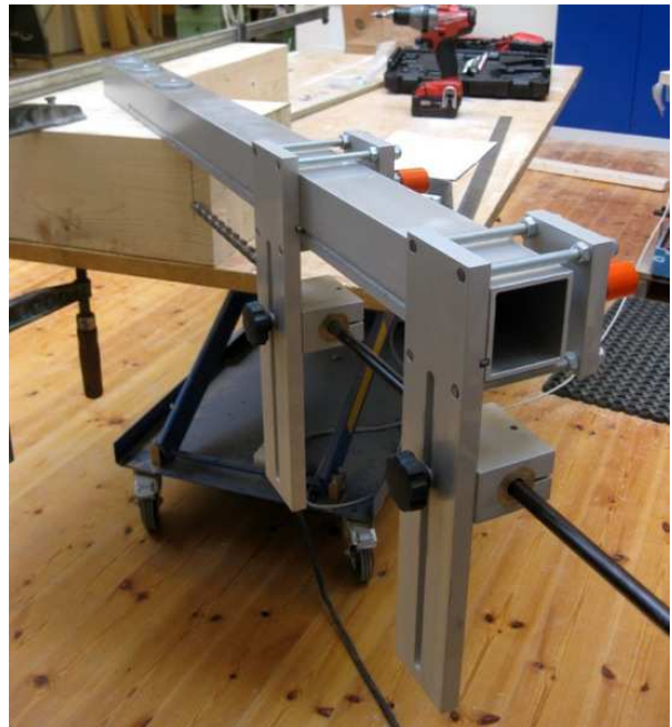
4. Etter vinkelen er montert, føres boret gjennom to opplager som justeres i ønskelig høyde på bjelken.
