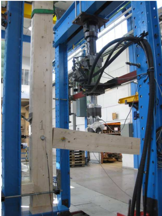
Figur 10: Forskyvning av bjelken etter brudd.
