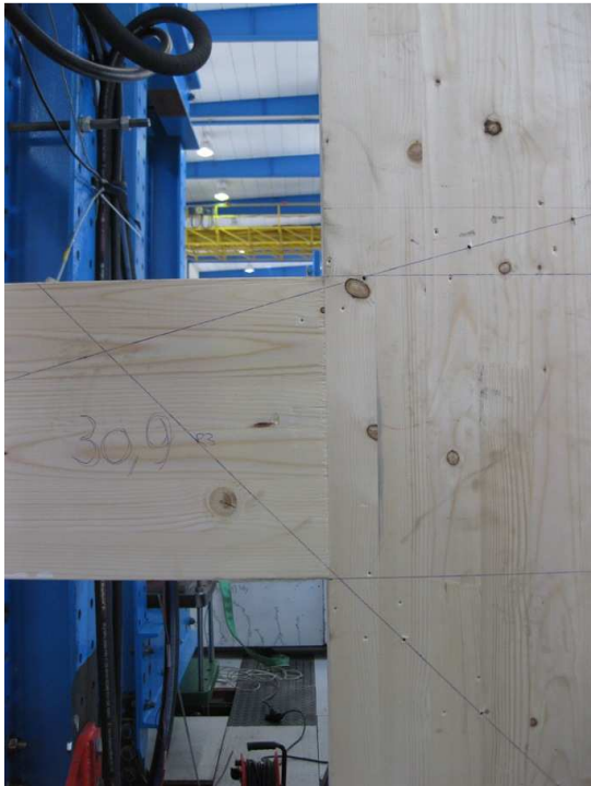
Figur 14: Sammenfestingen mellom bjelke og søyle før lastpåkjenning.
