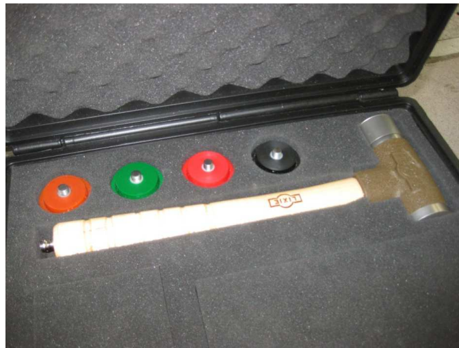
Figur 6.1: Bildet viser impulshammeren. Foto: Privat.
