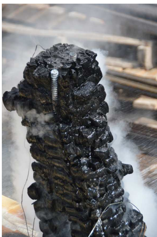
Figur 35: Forkulling av testforbindelse 8.
