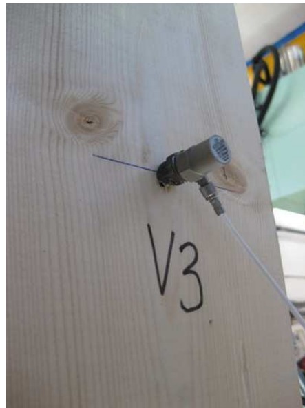
Figur 6.3: Boks som transporterer målingene til akselerometret. Foto: Privat.
