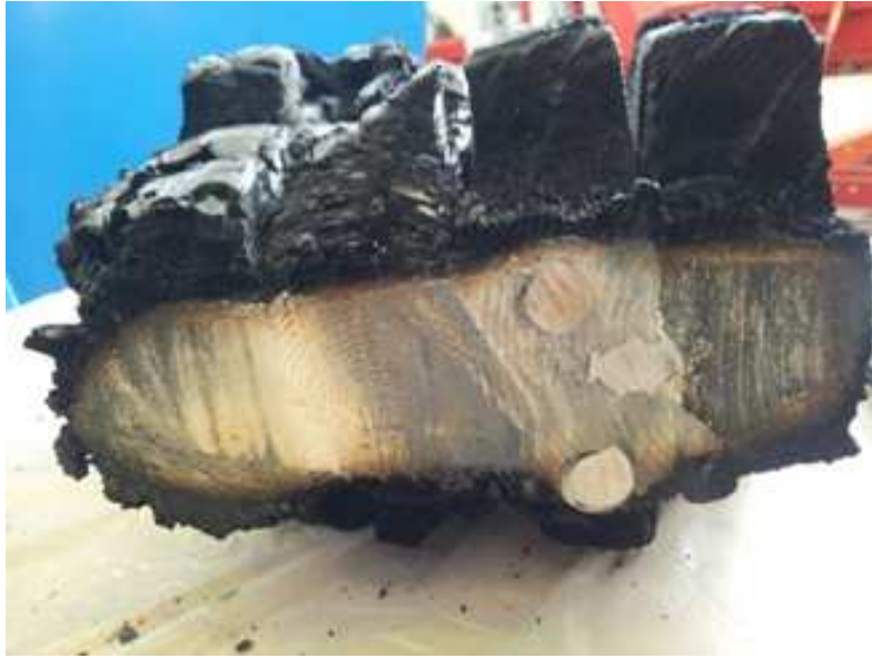
Figur 5.33: Bildet viser forkullet bjelketverrsnitt i snitt 2-2, hvor bildet er tatt av den ytterste bjelkedelen. Foto: Privat.
