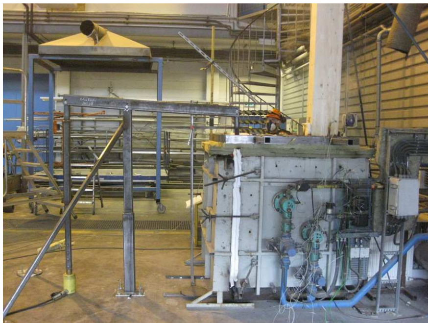
Figur 34: Skjevstilling i lastpføringsssystemet som oppsto underveis i test 8.
