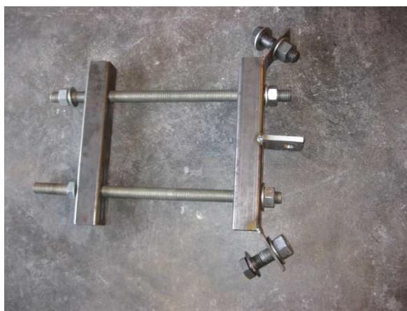
Figur 27: Forankring av strekkstag mot s ylen (Detalj E).
