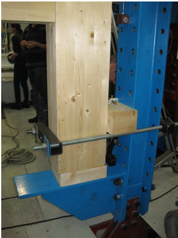
Figur 4: Opplagring av limtresøyle i bunn.
