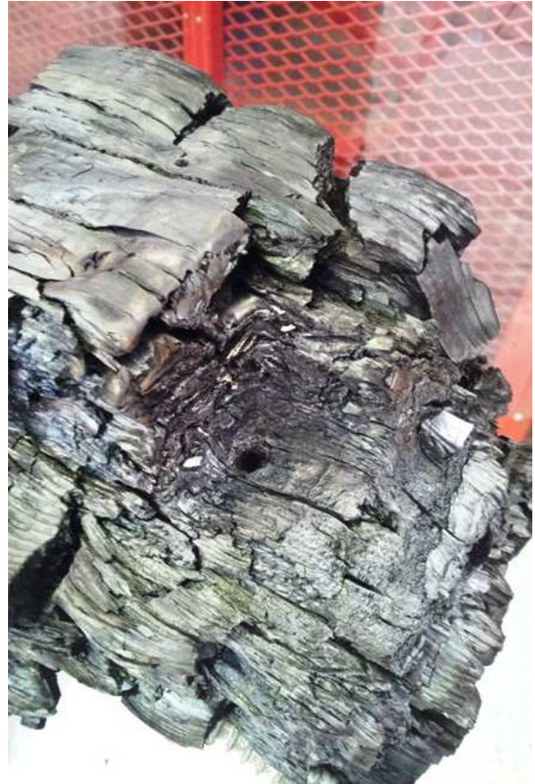
Figur 5.19: Bildet viser oversiden av bjelken ved fri ende. Hullet i treet kommer av at punktlasten ble festet med en skrue i bjelkens overside, for å sikre lastangrepspunktet. Foto: Privat.
