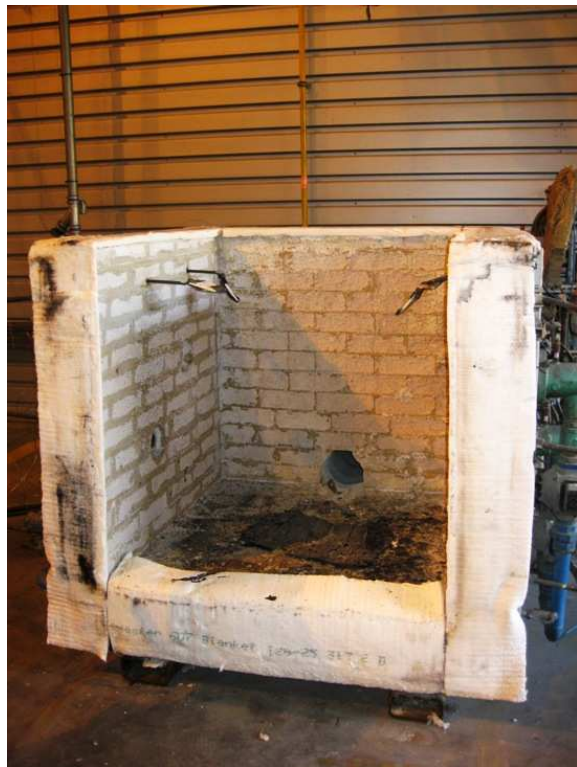
Figur 5.2: Bildet viser hvordan pilotovnen så ut innvendig. Termoelementene som registrerte temperaturen i ovnen stikker ut på innsiden av veggens på hver side. Foto: Privat.
