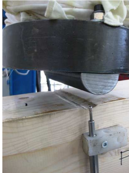
Figur 4.19: Bildet viser sammentrykning av bjelkens overside for test 1, som følge av påkjent punktlast. Foto: Privat.
