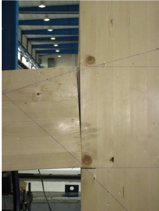
Figur 4.25: Bildet viser den strekkpåkjennte og den trykkpåkjennte delen av bjelketverrsnittet. Foto: Privat.
