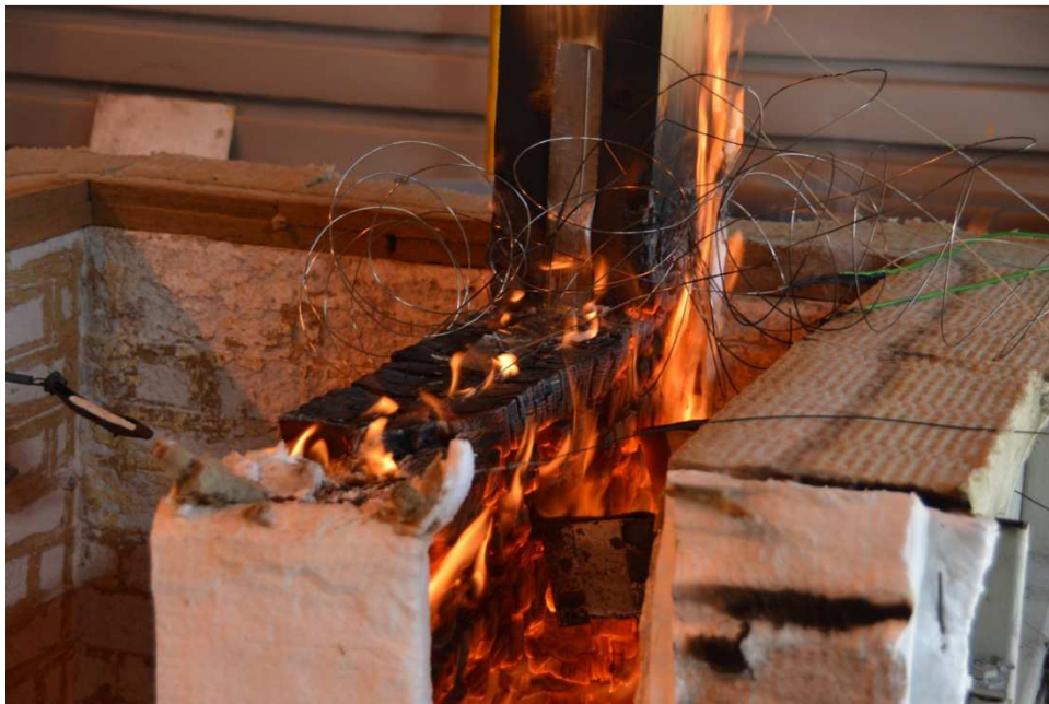
Figur 5.38: Bildet viser testforbindelse 6 etter at testen var avsluttet. Foto: Privat.
