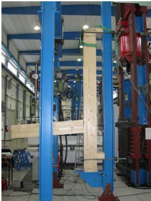
Figur 4.17: Bildet viser forskyvningen av bjelken ved maskimal last i test 1. Foto: Privat.
