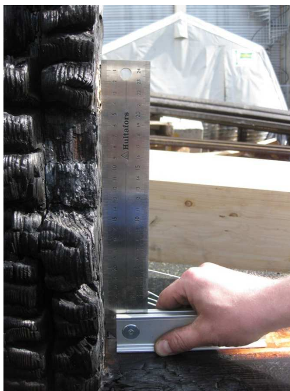
Figur 36: Vinkel mellom bjelkens overside og søylekant etter testen var over.
