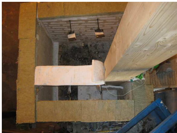
Figur 20: Ovn med testforbindelse sett ovenfra.
