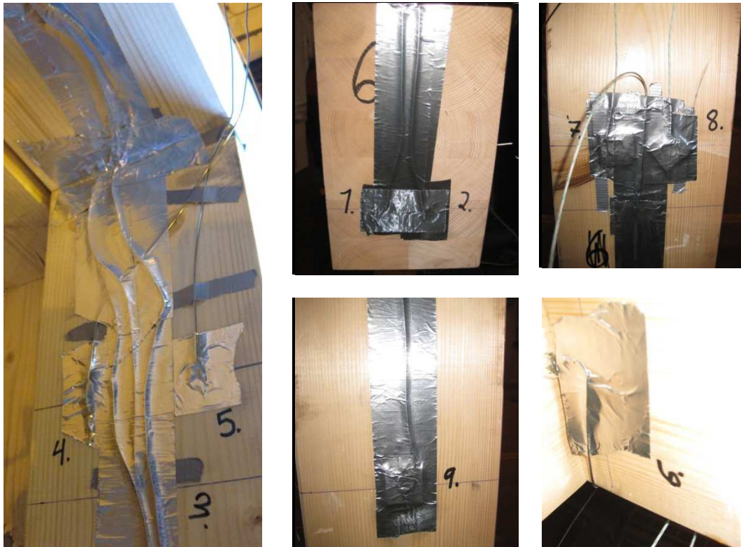
Figur 5.15: Bildet viser hvordan termoelementene i alle punkt. Det er lagt inn svinger på ledningene som tilhører quickdip termoelement utplassert i punkt 1, 2 og 3. Ledningene til de kapslete termoelementene i punkt 4 og 5 er trukket ut på høyre side av bjelken. Ledningene til termoelementene i punkt 7,8 og 9 er trukket opp langs søylen. Bildet som viser termoelementet i punkt 6 er tatt fra undersiden av bjelken. Foto: Privat.
