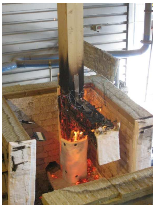
Figur 32: Testforbindelse 6 etter branntest.
