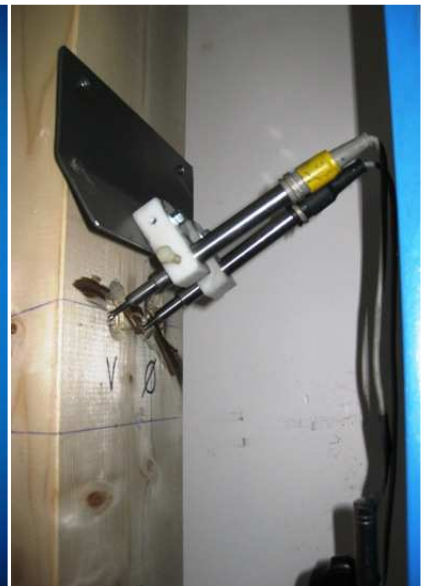
Figur 4.14: Forskyvningsmålere plassert ved skruendene i søylen. Forskyvningsmåler med navn V ble plassert ved skruen øst, og omvendt. Foto: Privat.
