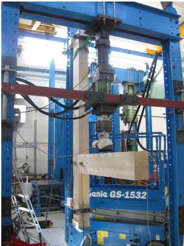
Figur 2: Testforbindelse sett fra siden.
