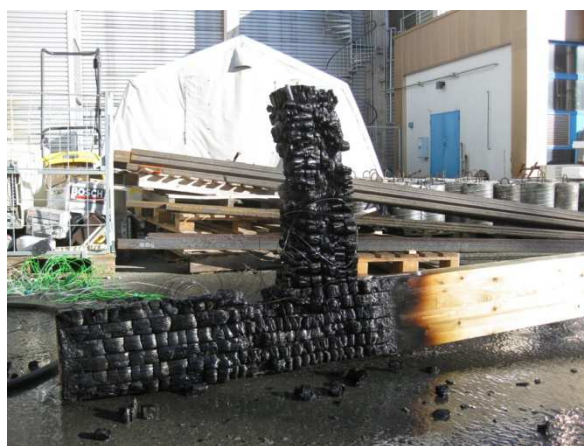
Figur 33: Forkulling av testforbindelse 6.
