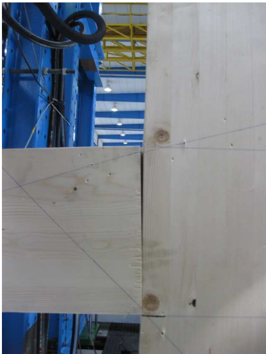
Figur 12: Åpning mellom søyle og bjelke.
