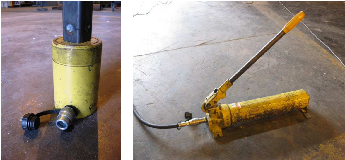
Figur 5.7: Bildet viser jekken som ble benyttet for å påføre bjelken konstant last. Foto: Privat.
