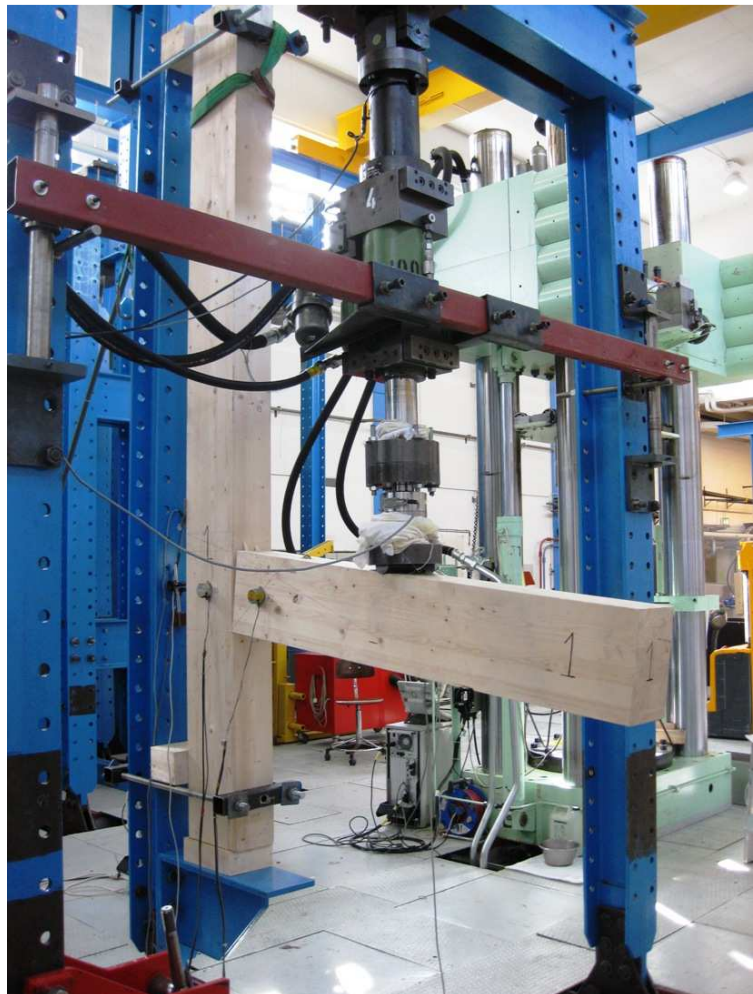
Figur 4.7: Bildet viser utformingen av den hydrauliske jekken som ble bruk for lastpåføring. Foto: Privat.
