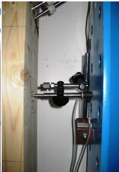
Figur 4.13: Forskyvningsmåler F1 måler utbøyningen av søylen. Foto: Privat.
