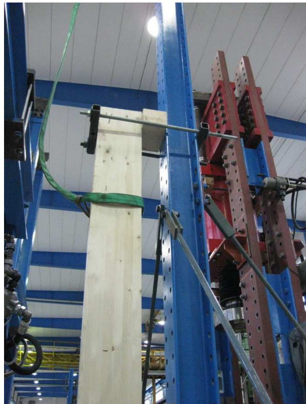
Figur 5: Opplagring av limtresøyle i topp, innfesting av strekkstag i stålsøylen.
