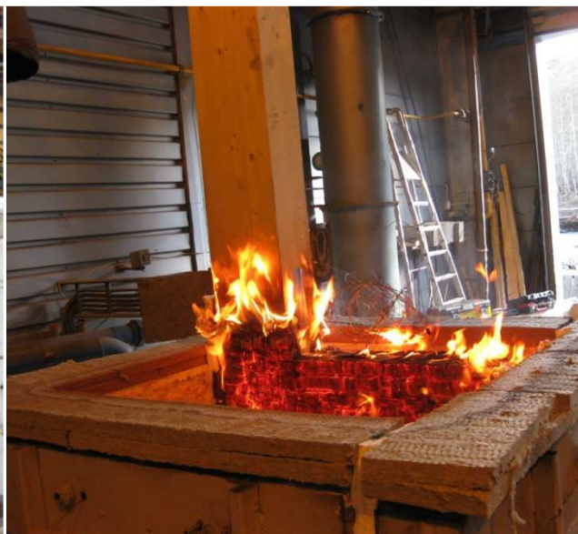
Figur 31: Bilde av testforbindelse 6 like etter lokket ble løftet av.
