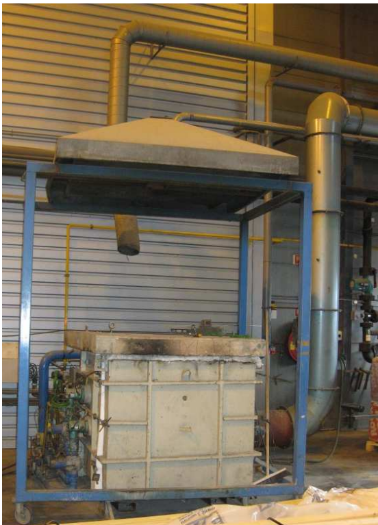
Figur 5.1: Bildet viser pilotovnen som benyttes til branntesting. Gassbrennere stikker ut på hver side av ovnen. Stativet som er plassert over ovnen ble fjernet under testingen. Foto: Privat.
