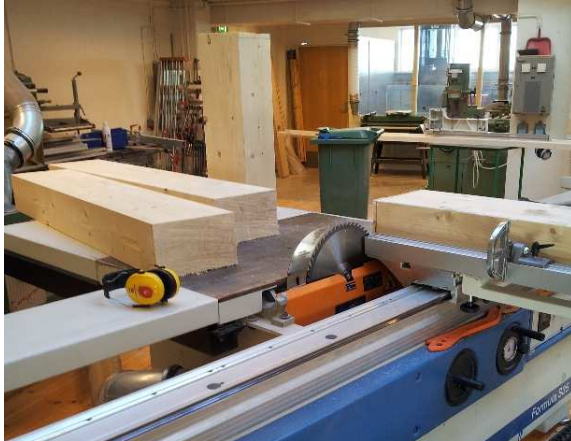
1. Limtrebjelker kappes ved bruk av en klyvsag.
