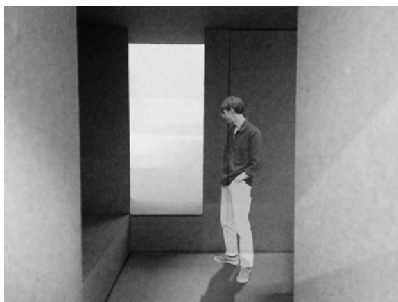
Dagslysundersøkelse av cellen med 0,9 m tykk yttervegg
