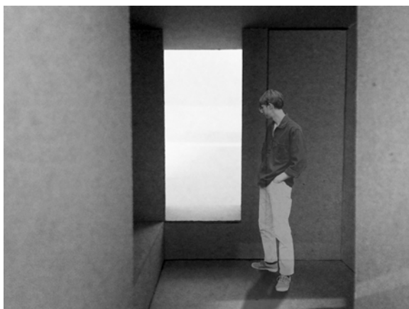
Dagslysundersøkelse av cellen med 1,0 m tykk yttervegg
