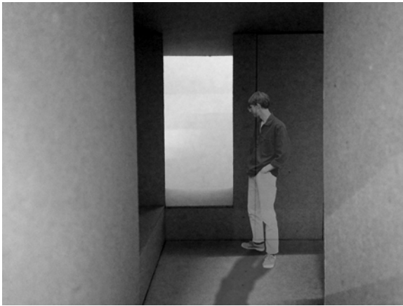
Dagslysundersøkelse av cellen med 1,5 m tykk yttervegg
