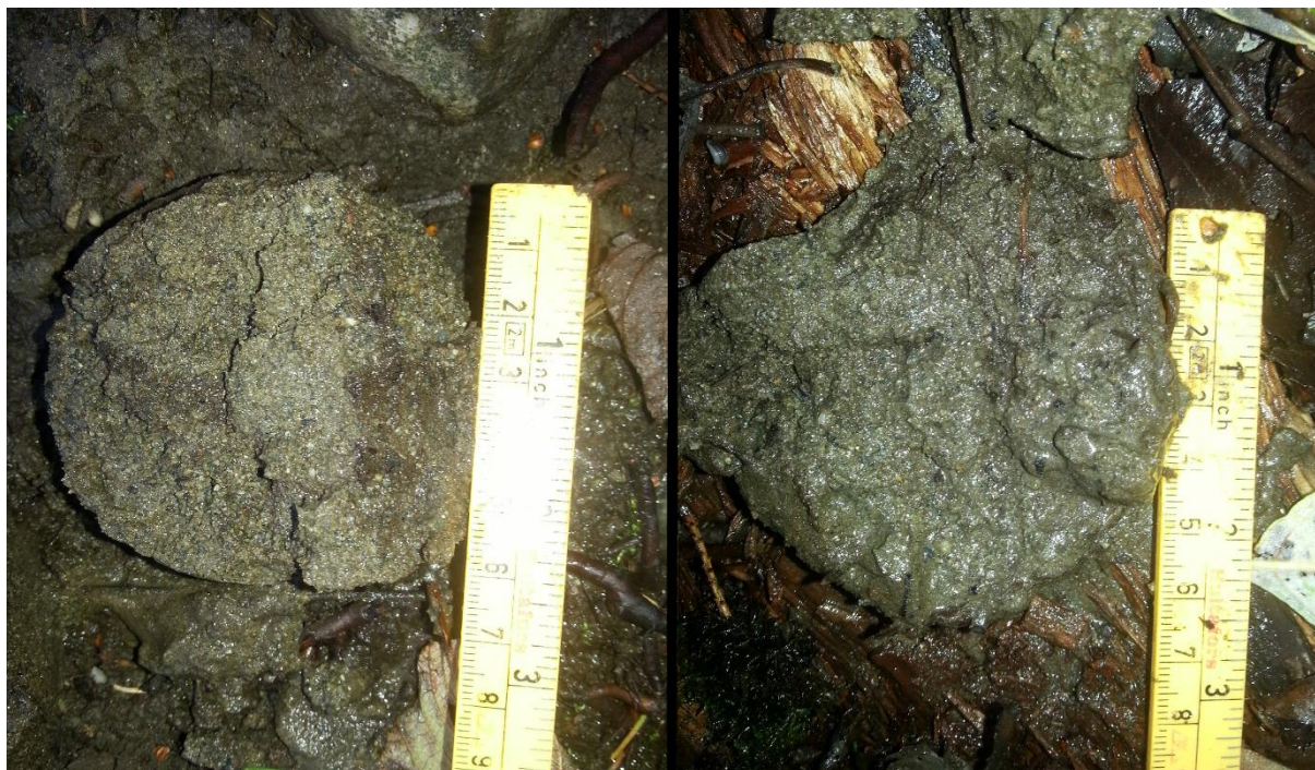
Figur 30: Sedimenter fra Storlykkja etter å ha blitt tatt ut av sedimentprøvetakeren. Bildet til venstre er fra stokkdam Storlykkja, bildet til høyre fra kvistdam Storlykkja. Bildene er tatt 27.10.2014.
