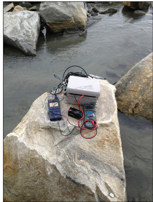
Figur 14: Plassering av EC-måler og datalogger ved smeltevannets utløp (markert ved punkt 3 i figur 12).
