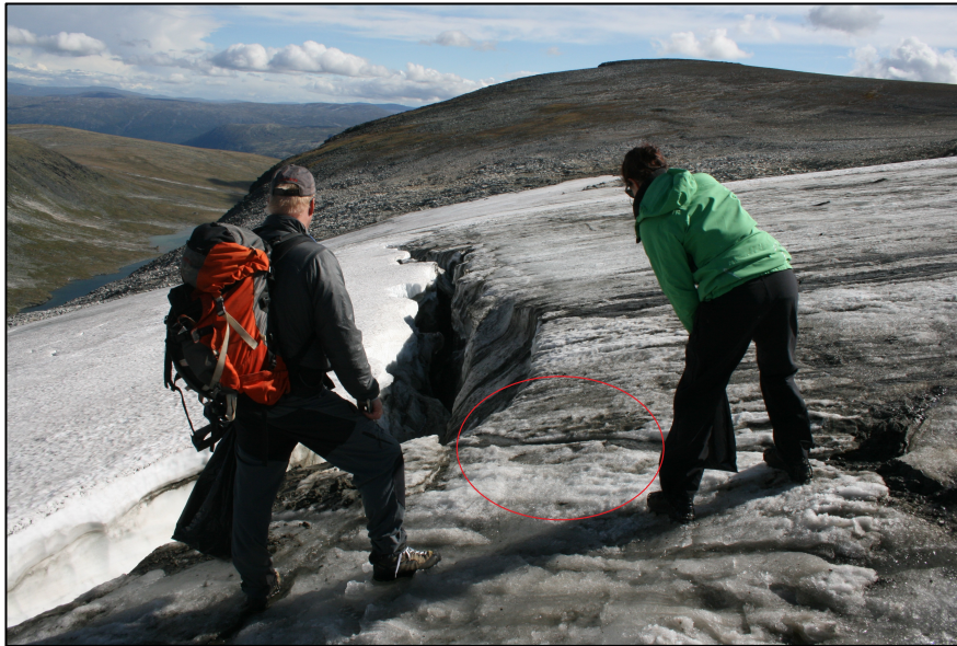
Figur 13: Kanal 1 hvor både Rhodamin WT og NaCl ble injisert ved tre feltturer august og september 2014. Rød sirkel markerer kanalen. Foto: Oda Kamilla Eide, 2014.
