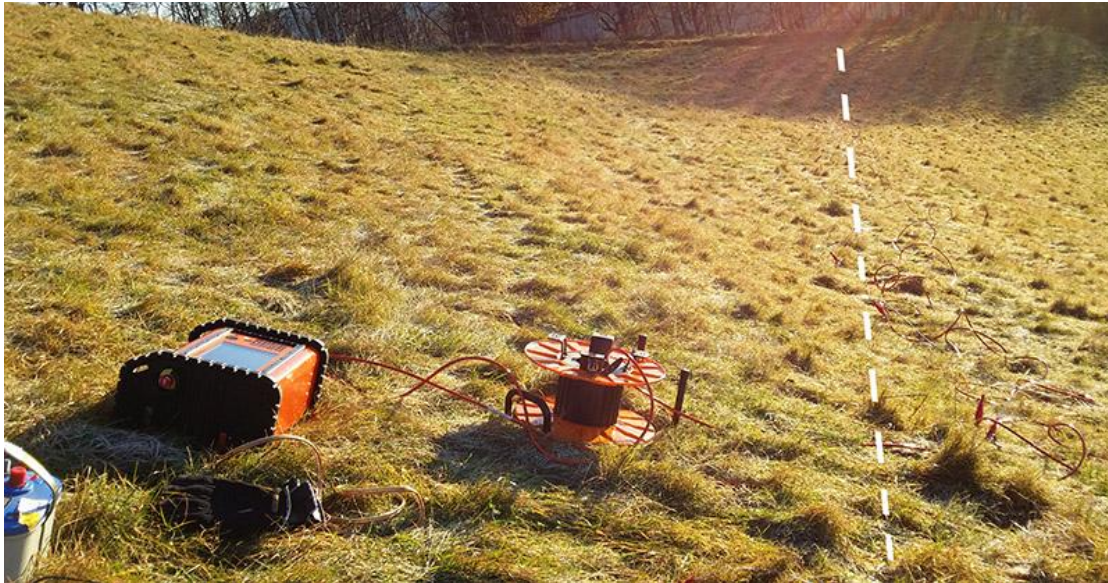
Figur 22 Måleoppsett, med terrameteret, eksternbatteri, kabeltrommel, elektroder med jumpere. Hvit stiplet linje viser 40meter/halvt målestrekk fra L.1 der elektrodene er satt ned. (Foto: Kenneth T. Rudolfson)
