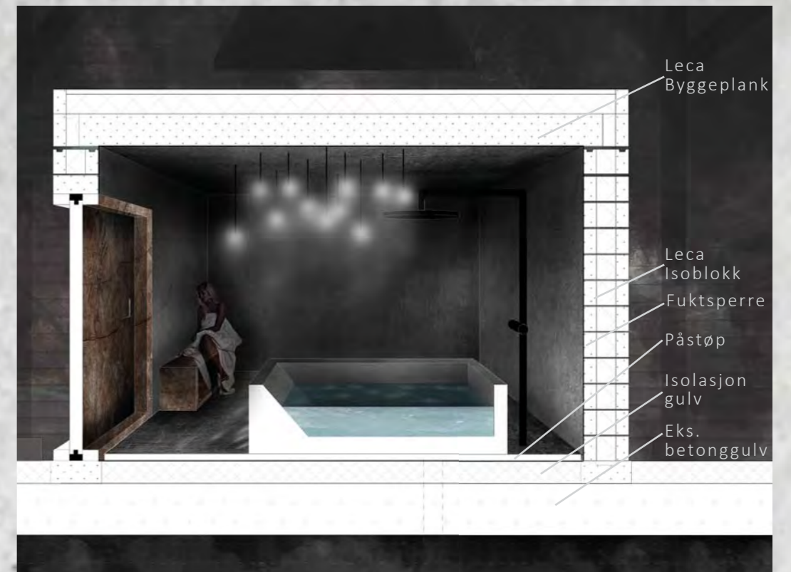
1 m Detailssnitt Klimatisert badromskjerne av leca-blokker
