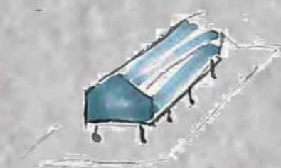
"Skjære bort den nedre delen av veggen.
