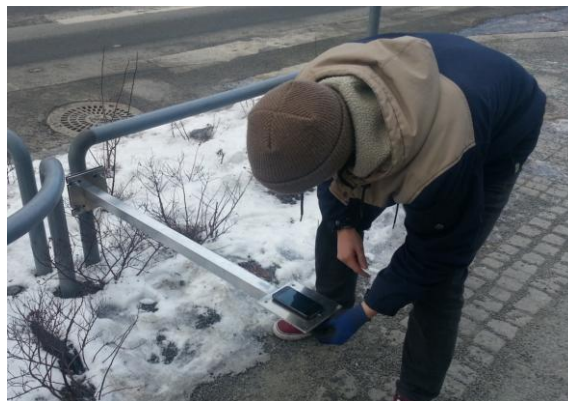
Figur 5.18: Vibrasjonstest av anemometerbraketten utendørs
