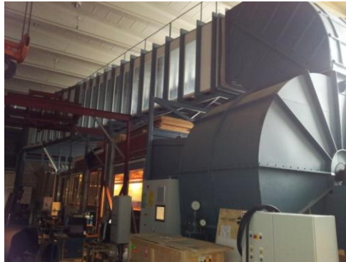
Figur 6.4: Vindtunnelen på det aerodynamiske laboratoriet ved Institutt for energi- og prosesssteknikk ved NTNU, som ble benyttet til testing av anemometerkonstruksjonen
