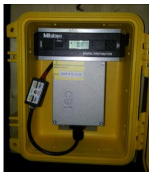
Figur 3.34: Montert akselerometer Gjemnessundbrua
