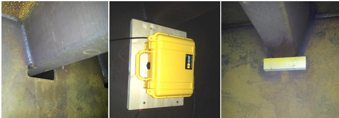
Figur 3.17: Akselerometerkassen ble loddet og fastmontert for at akselerometrene skal gi resultater i riktig ortogonalt aksesystem og med minst mulige forstyrrelser
