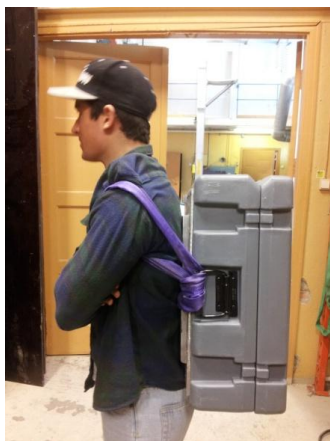
Figur 3.13: Registreringskassen til hovedloggestasjonen i tårnet på Gjemnessundbrua bæres på ryggen ved hjelp av en løftestropp
