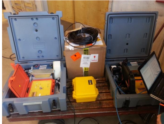
Figur 3.1: Registreringsnode (t.v.), akselerometerkasse (i midten) og hovedloggekasse (t.h.)
