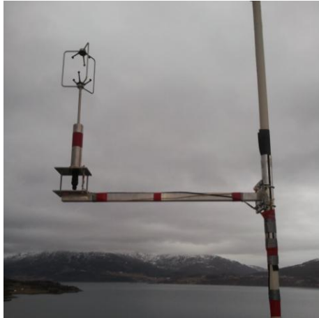
Figur 3.23: Anemometeret montert på hengestang. Rød tape benyttet for å synliggjøre anemometerkonstruksjonen
