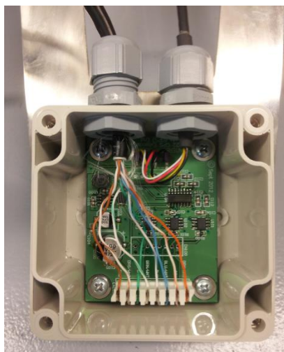
Figur 3.6: Kobling av GPS mottaker
