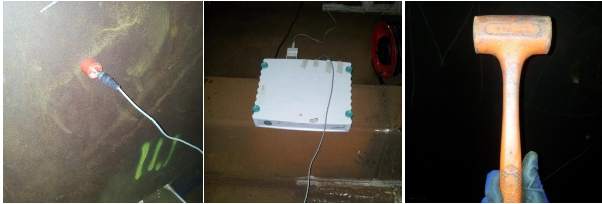
Figur 7.11: Akselerometer B12/500 med magnet (t.v.), Spider8 (midten) og gummihammer (t.h.)
