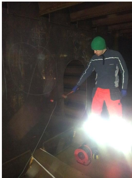
Figur 7.10: Testing av tverrskott på Gjemnessundbrua
