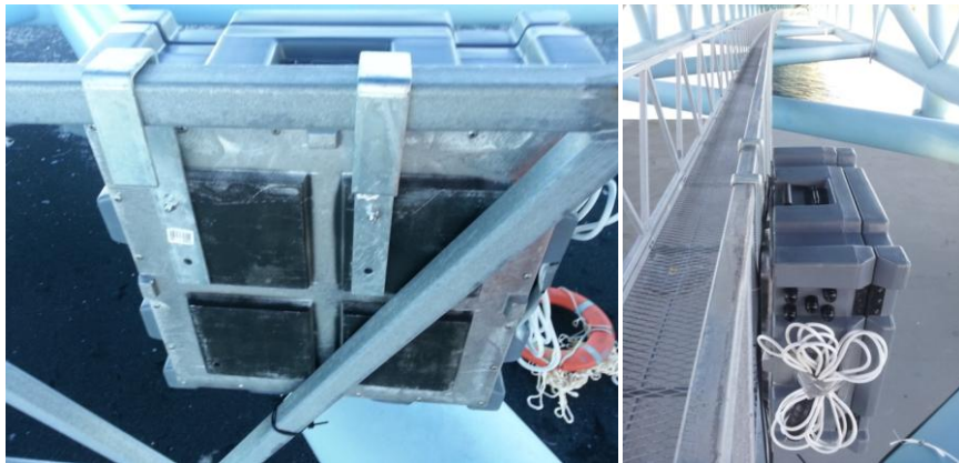
Figur 3.29: Registreringskasse montert på rekkverket på gangbanen under brudekket
