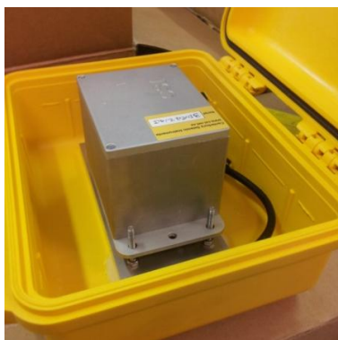
Figur 3.33: Montering av akselerometersensor i kasse
