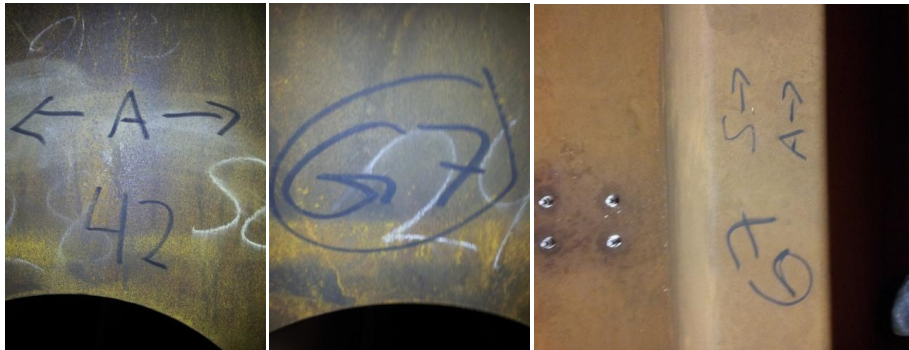
Figur 3.15: Merking på tverrskott av akselerometerplassering og hengestangnummer (t.v.), merking på tverrskott av plassering av registreringskasse (i midten) og merking av plassering og orientering av registreringskasse på bunnplate (t.h.)
