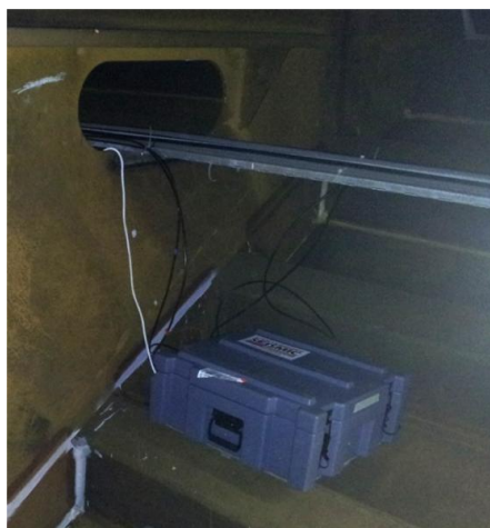
Figur 3.19: Plassering av registreringskasse, og kabelbanen gjennom tverrskottene
