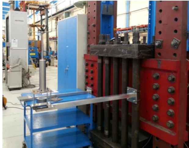
Figur 5.8: Testing av anemometerkonstruksjon på laboratoriet til Institutt for konstruksjonsteknikk ved NTNU
