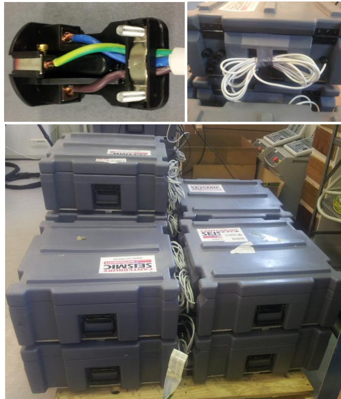
Figur 3.11: Forberedelser av strøpstøpsel til registreringsnoder
