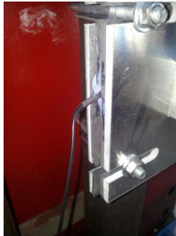
Figur 5.19: Temperaturmåleren klemt og fuget mellom gummilagene
