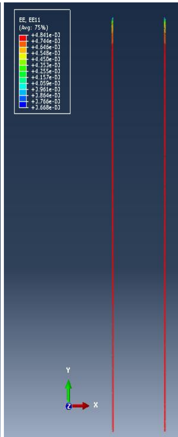
Figur F.4 Elastisk tøyning i spennarmeringen
