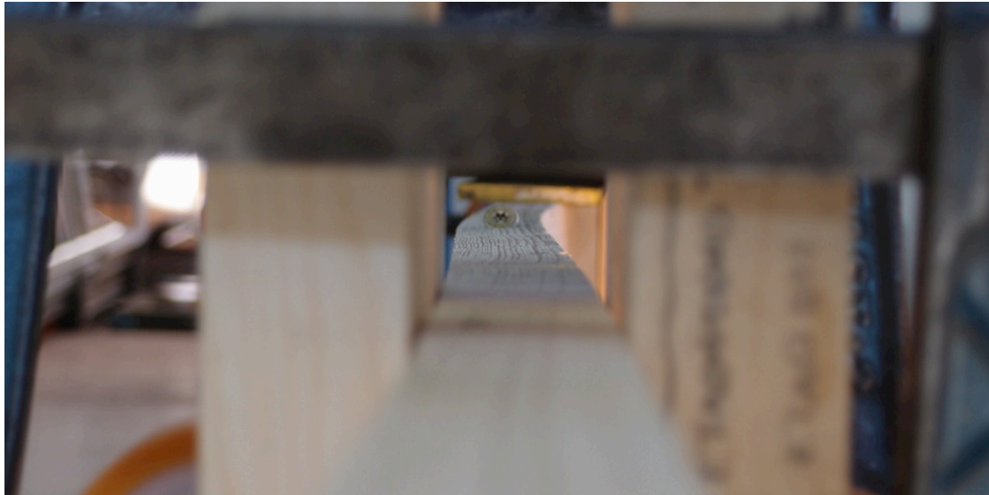
Figur 141: Stage 400, Lokal utbøyning
