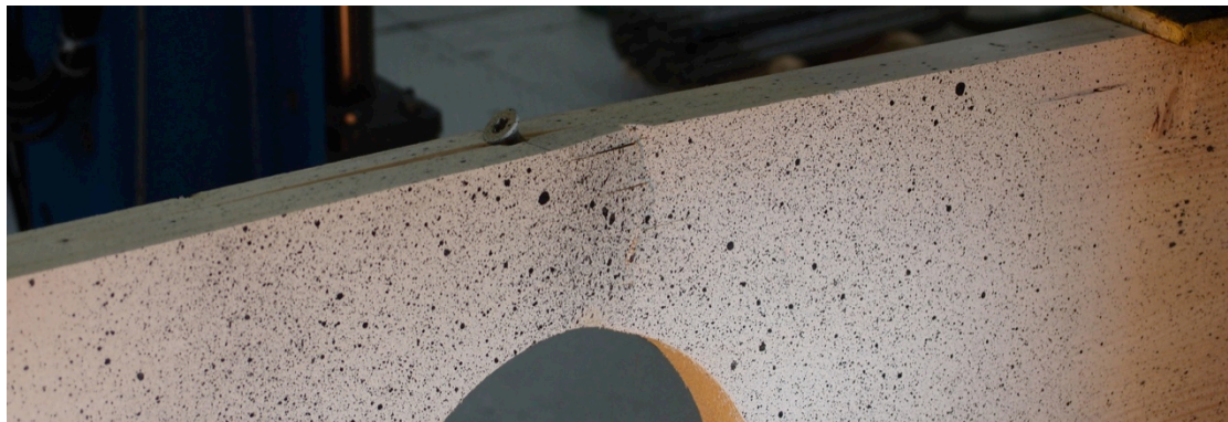
Figur 123: Lokal utbøyning av bjelke
