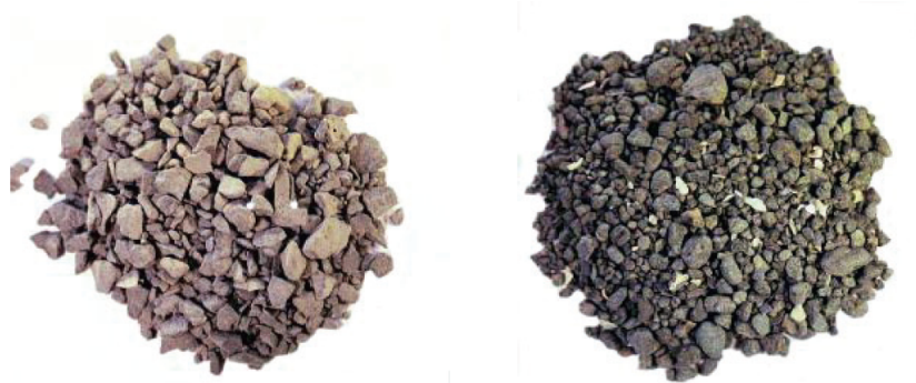
Figur 5.4: Maskinknust sand (venstre) og natursand (høyre) [53]
