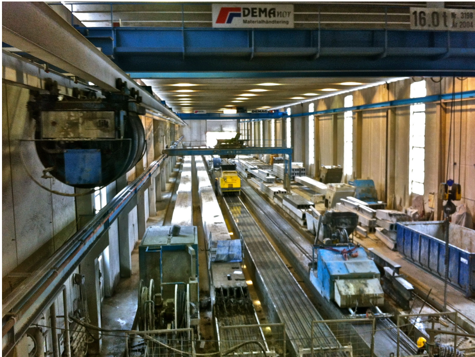
Figur 8.1: Hulldekkeproduksjon på Stjørdal
