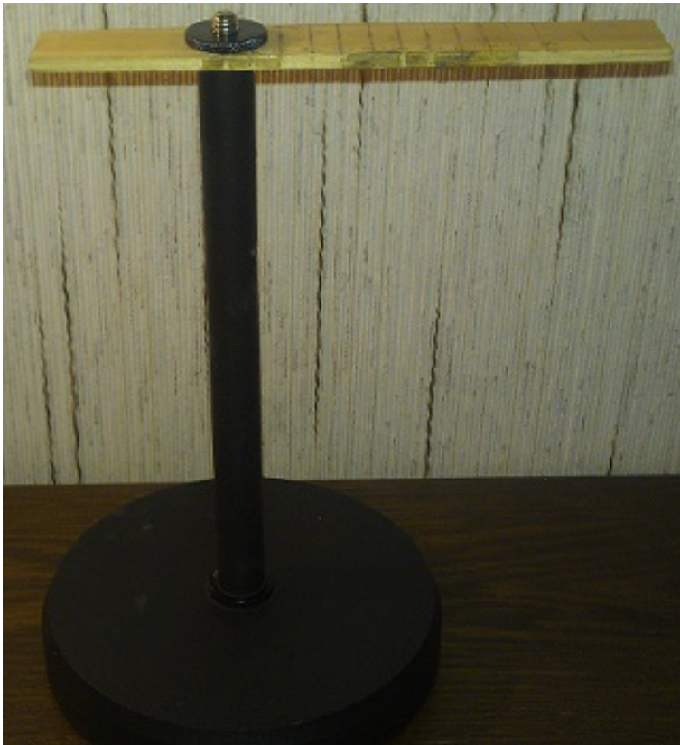
Figur 4.5: Foto av «målepinne» montert på stativ
