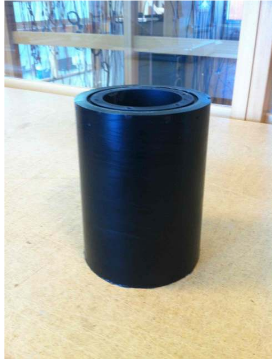
(f) Etter støping med farget epoxy
