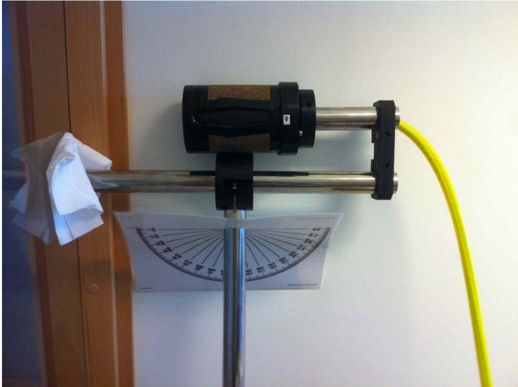
Figur 26: Testjig med tildekt transducer
