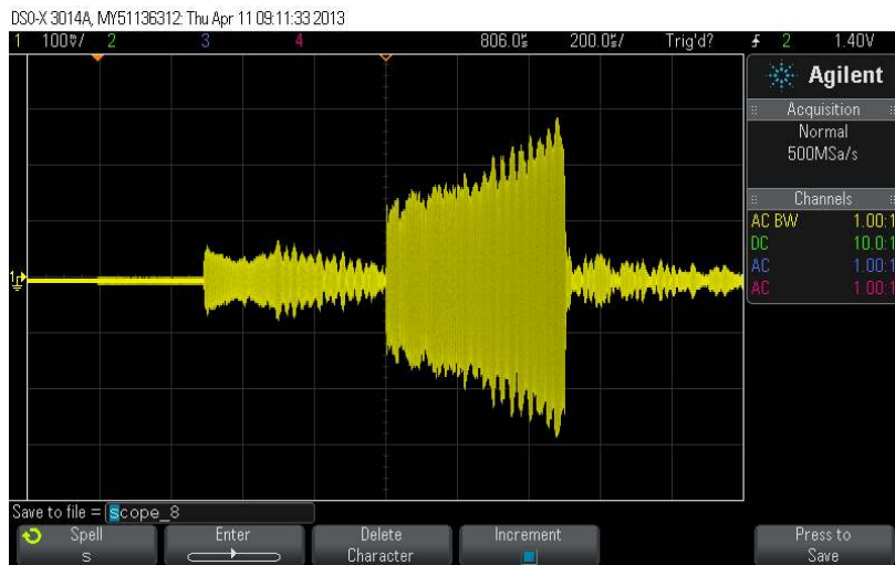
(b) Skopbilde med sender lavt i tanken
