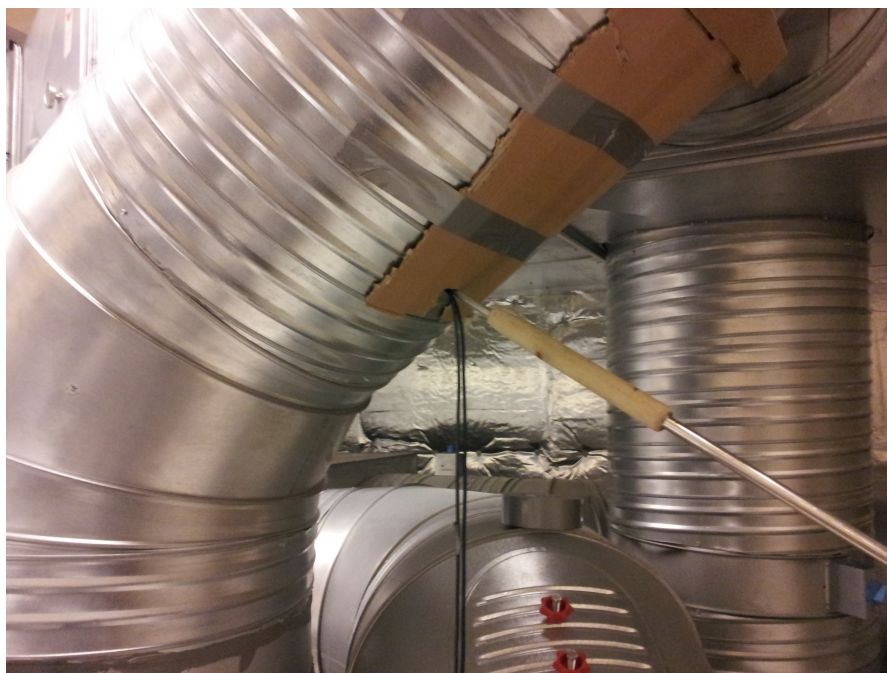
Figur 4.3: Måleoppsett for måling av lydeffekt fra ventilator.
