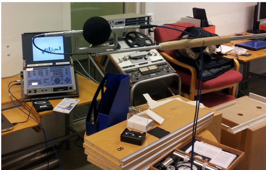
Figur 4.1: Probe koblet opp mot sanntidsanalysator
