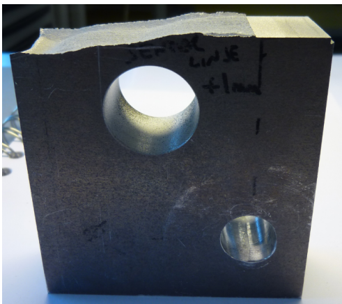
Figur 4.21: Plate med hull, prøvestykke 1-0, bruddflate
