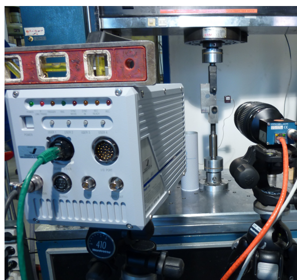
Figur 4.6: Oppsett for platen med hull. Høyhastighetskamera til venstre, høyoppløst kamera til høyre
