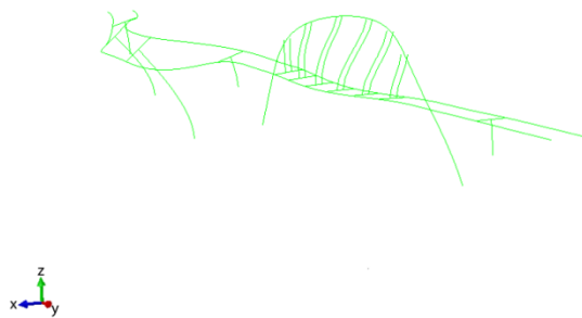
Mode nr.5 med egenfrekvens 1,01 Hz.
