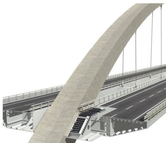
Figur 3. Hvordan kjørebanelene er koblet til buen [2].
