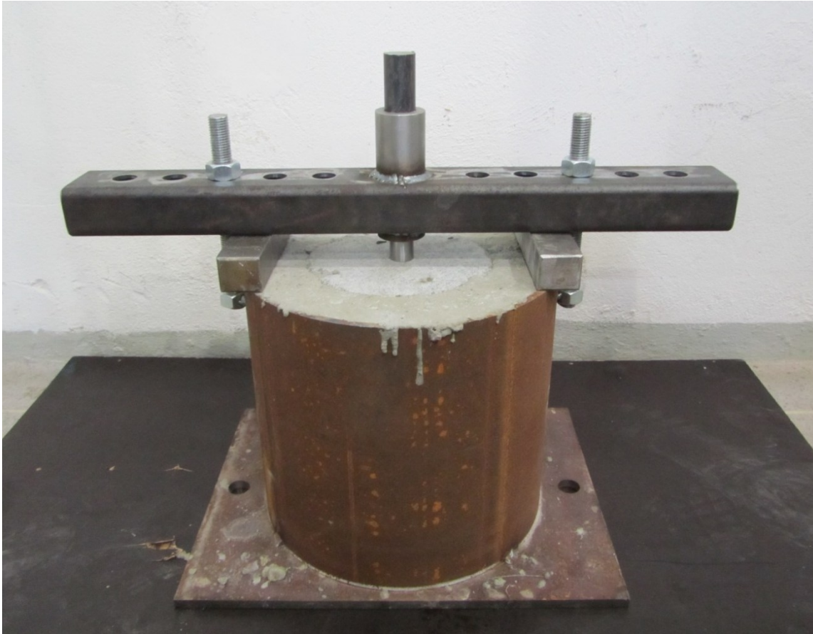
Figur 5.5: Stålrør med prøve og holder
