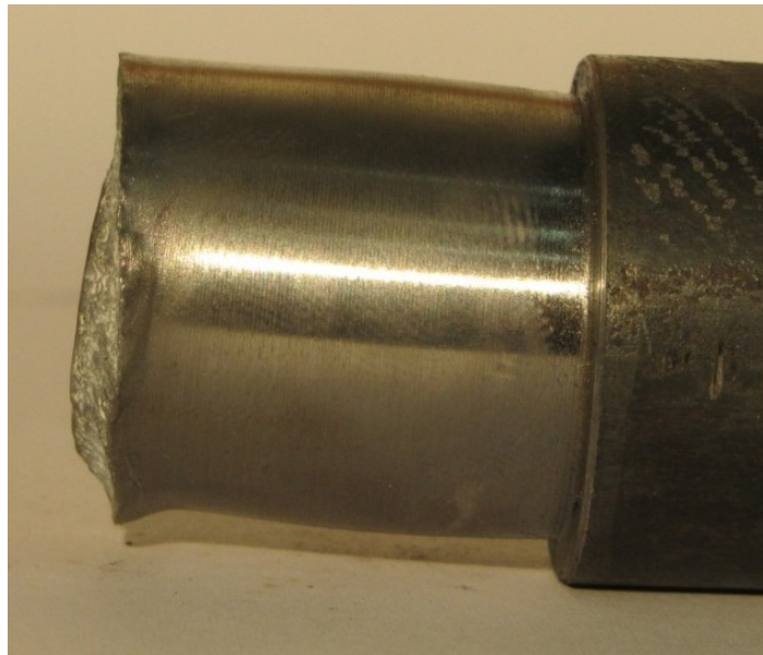
Figur 5.13: Plastisk deformasjon av uherdet spiss rammet mot betong med forboring
