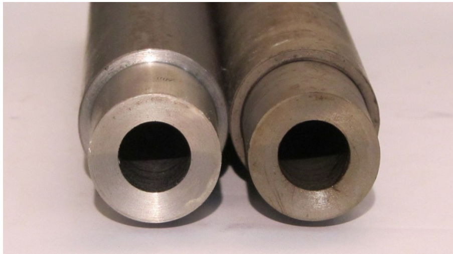
Figur 5.3: Sammenligning av uherdet spiss
