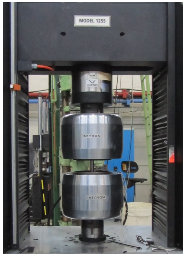
Figur 5.23: Strekkforsøk av prøve A1 i en Instron 1255 testmaskin
