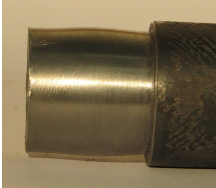
Figur 5.12: Plastisk deformasjon av uherdet spiss rammet mot betong uten forboring
