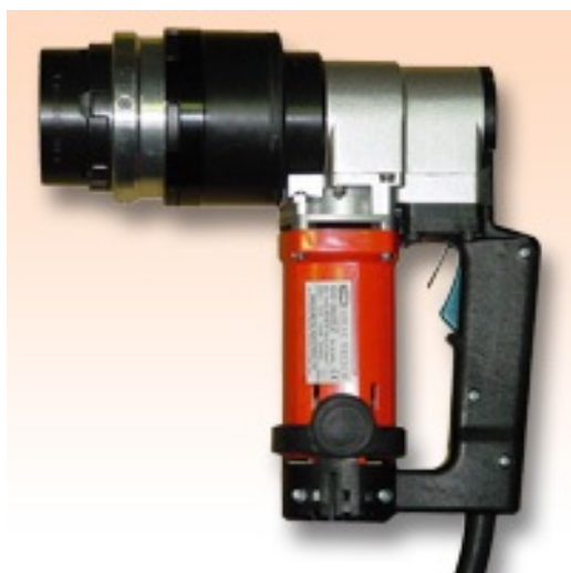
5.42 Bilde og mål på eksempelverktøy for stramming av bolter [34]
