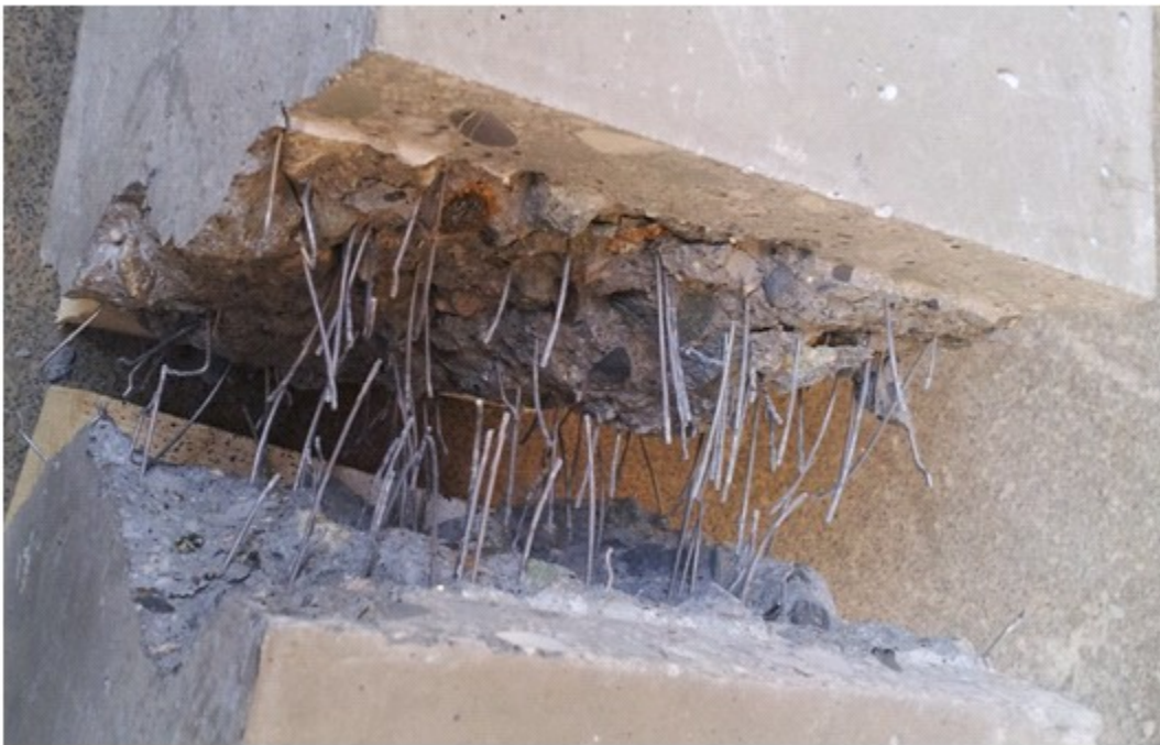
Figur 4.10: Stålfiber som krysser bruddflaten.
