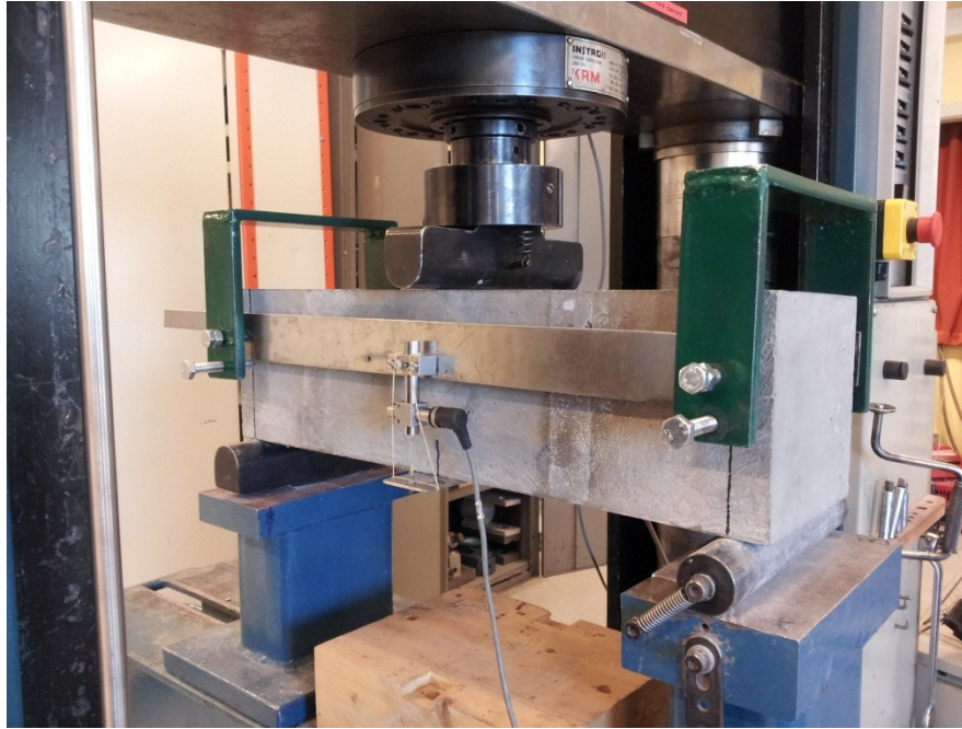
Figur 4.5: Testmaskinen med betongbjelke klar for testing. Lasten påføres nedover. Nedbøying og last avleses med 2 Hz.
