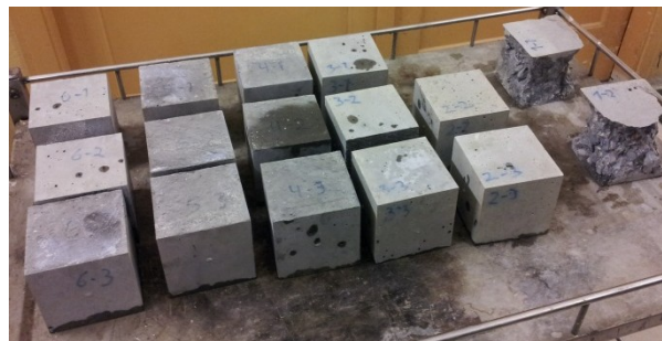
Figur 4.2: Betongterninger klare for trykktesting. De to prøvene helt til høyre er allerede testet.
