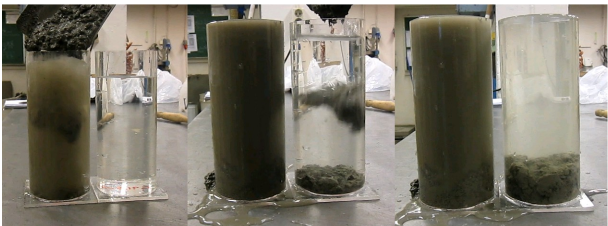
Figur 3.5: Ordinær betong til venstre, undervannsbetong til høyre.
