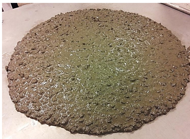
Figur 3.1: Referansebetongen etter synkmåling.
