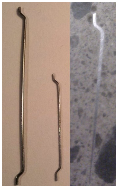
Figur 2.17: Dramix stålfiber HE 6560 (t.v.) og HE 6535 (midten). Fiber i pusset betonggulv (t.h.).
