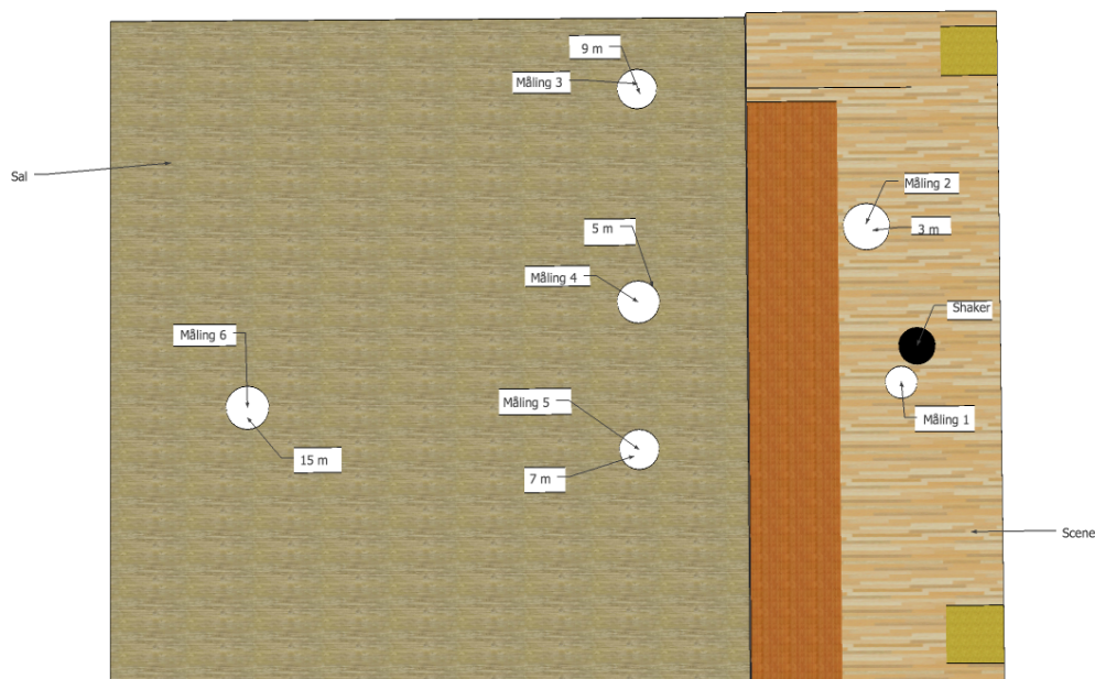
Figur 3.4: Skisse av mikrofonplasseringene som ble brukt i lydtrykksmålingene i Logen
