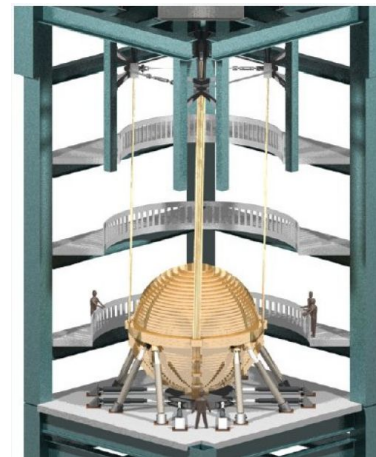
Fig. 2.4: TMD in Tapei 101
