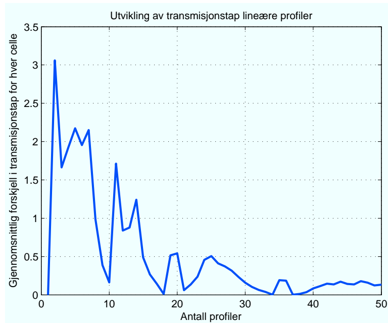
Figur 6.13: Konvergens med ligning (5.5) som kostfunksjon i ligning (5.3). Lineære profiler.
