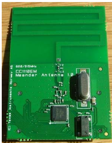
Figur 4.4: Meanderantennen produsert ved TI. Tilpasningsnettverket kan sees i overgangen mikrostriplinj - antenne (C2, R1 og C3).
