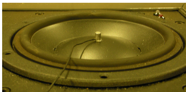
Figur 11: Plassering av akselerometer på høyttalerelementet
