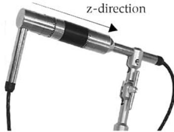
Figur 5: Eksempel på en intensitetsprobe. Z-retningen på bildet er retningen til lydforplantningen
