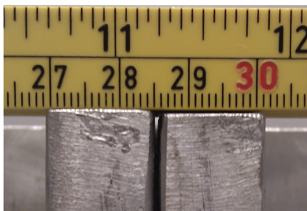
Figur 7.23: Restgap i prøvestykke
