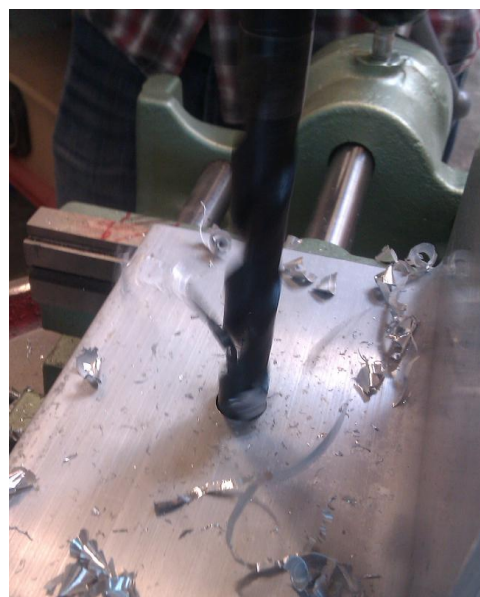
(b) Boring av T-stykker
