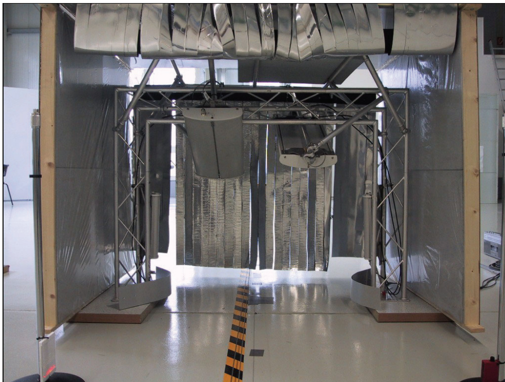
Figur 4.4: Innhyllingskonstruksjon sett fra posisjonen til innkommende bagasje. [86]
