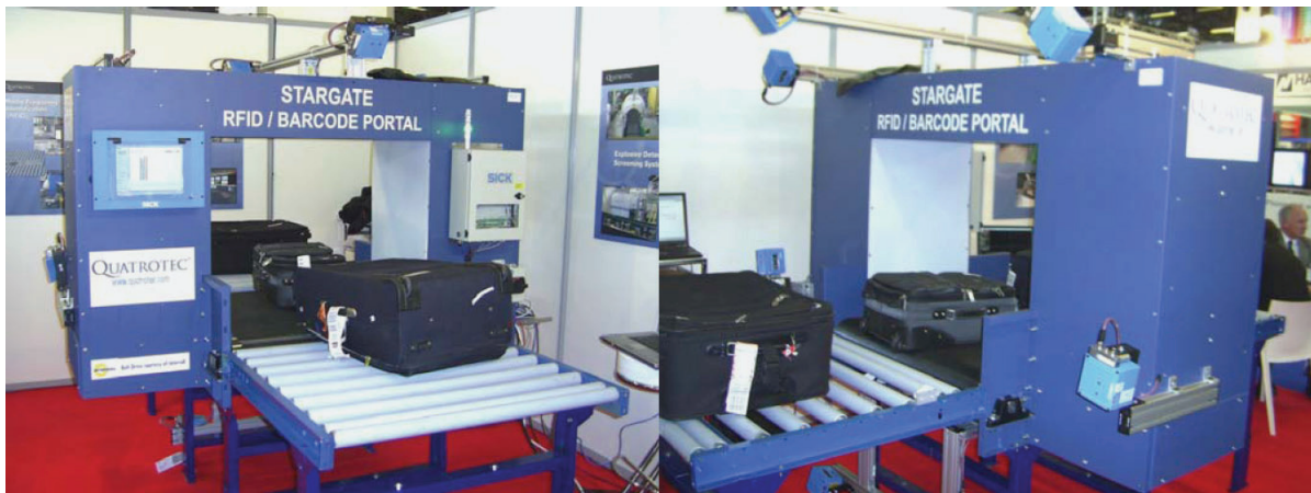
Figur 6.3: Kombinert strekkode- og RFID-lesestasjon, konstruert av Quatrotec og Sick.
