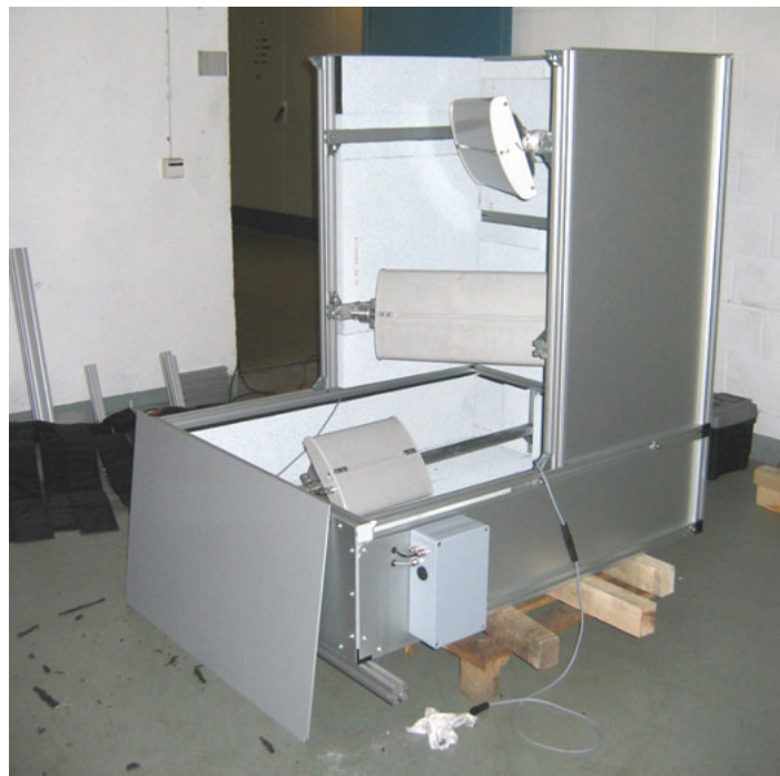
Figur 5.1: Montering av RFID-lesestasjon.
