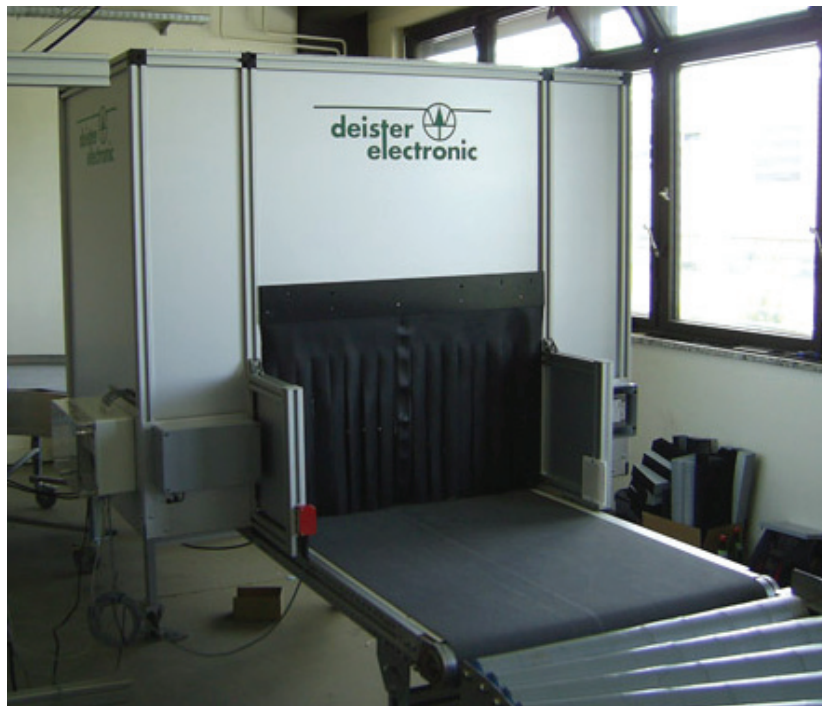
Figur 4.6: RFID-lesestasjonen installert ved Accu-Sorts lokaler.
