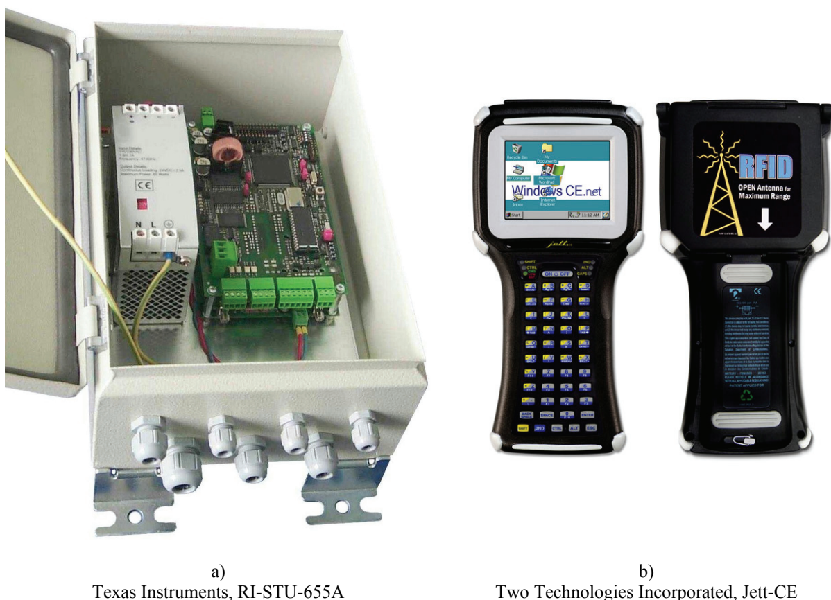
Figur 2.8: Eksempel på en stasjonær og en håndholdt leser. [25] [26]
