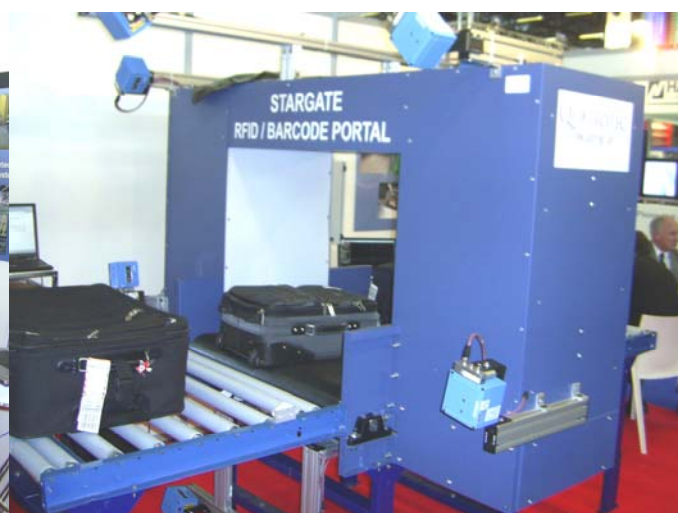
Figur 4.8: Sick og Quatrotec sin UHF-lesestasjon med Alien Technology
