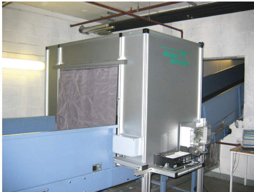
Figur 5.2: Ferdig montert RFID-stasjon.
