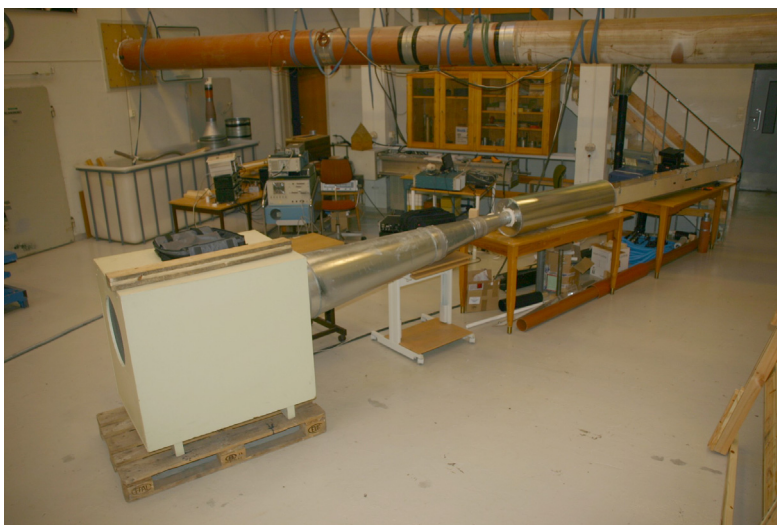
Figur 13: Fra venstre, Vifte med innsnevring, lyddemper og rør.
