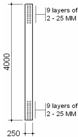
Figur 4.2: Tverrsnitt av veggskive brukt i parameterstudie (Hovind, 2011).
