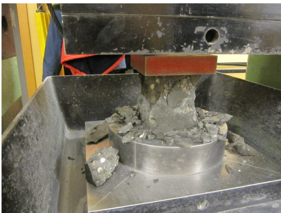
Figur 23 Terning i brudd under forsøk
