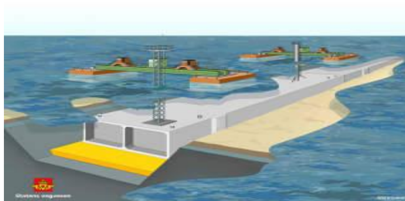
Figur 3 Illustrasjon fra byggingen av senketunnelen i Bjørvika
