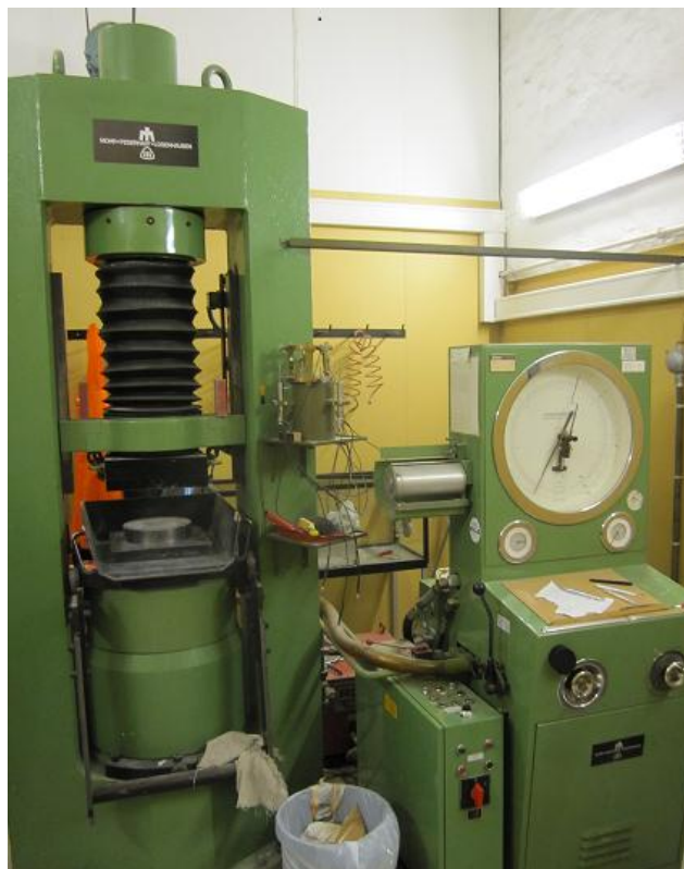
Figur 22 Losenhausen-maskin for trykktesting
