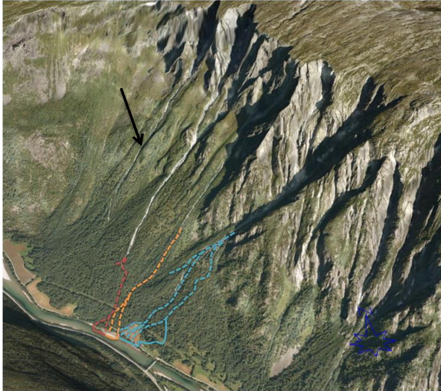
Figur 10: Oversiktsbildet over Øster-Ottem er hentet fra Norge i 3D. Skredbane og utløpsområde har blitt stiplet inn ca. der de har gått. Sort pil indikerer en fjerde skredbane, der skredmassene ikke kom helt ned til veien, men vil bli videre introdusert under «andre potensielle skredområder».
