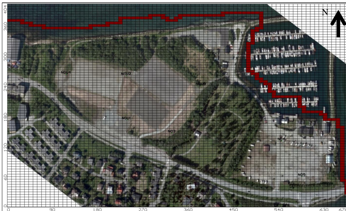
Figur 4.7: Rutenett med konstant grensebetingelse (rød farge) for lag 2 i Visual MODFLOW 2011.1
