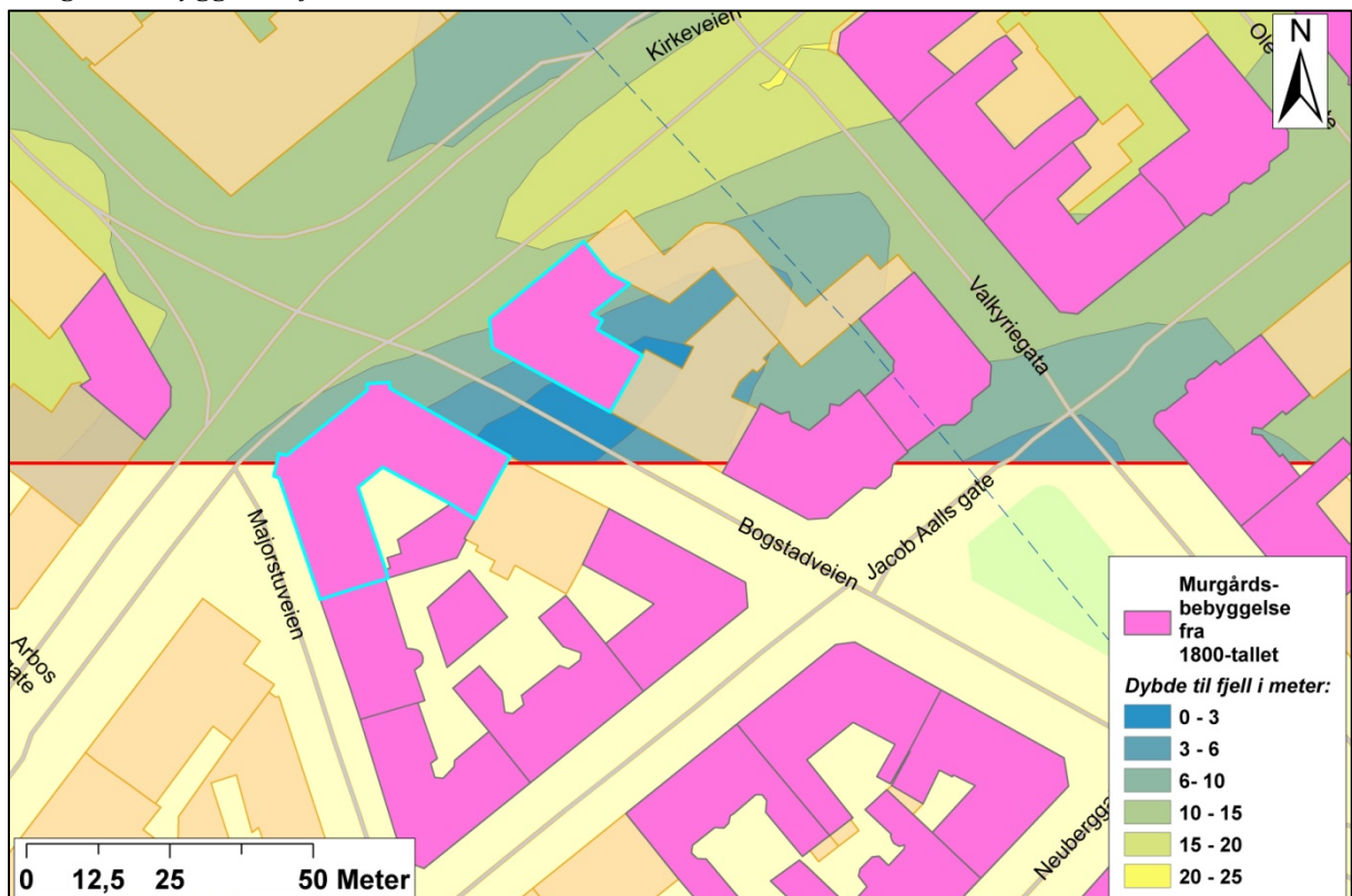
Figur 4.9. Kartet gir et nærmere bilde av murgårdsbebyggelsen som ligger delvis på fjell og delvis løsmasse. De to byggene er streket rundt med turkis. Potensielt sett kan deler av det nordligste bygget ha en løsmassedybde på 15 meter. Det sørligste bygget kan ha en løsmassetykkelse på 10 meter (innenfor studieområdet).
