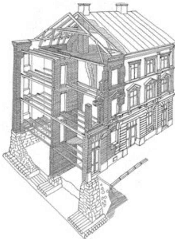
Figur 2.2 Snitt gjennom en typisk murgård fra 1800-tallet (Bjørberg et al., 2011)
