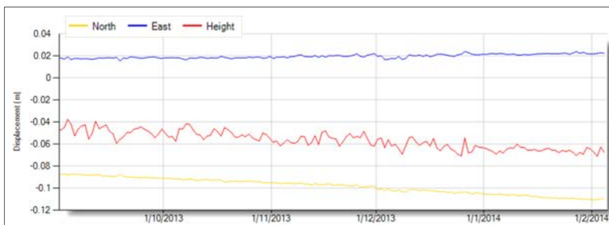
Figur 5.19. GPS 4 rørsle frå 01.09.13-01.02.14. \Delta Nord= -0.02419 m, \Delta Aust= 0.00522 m og \Delta Vertikal= -0.02325 m. Figur frå ÅTB software ved Lars Harald Blikra.
