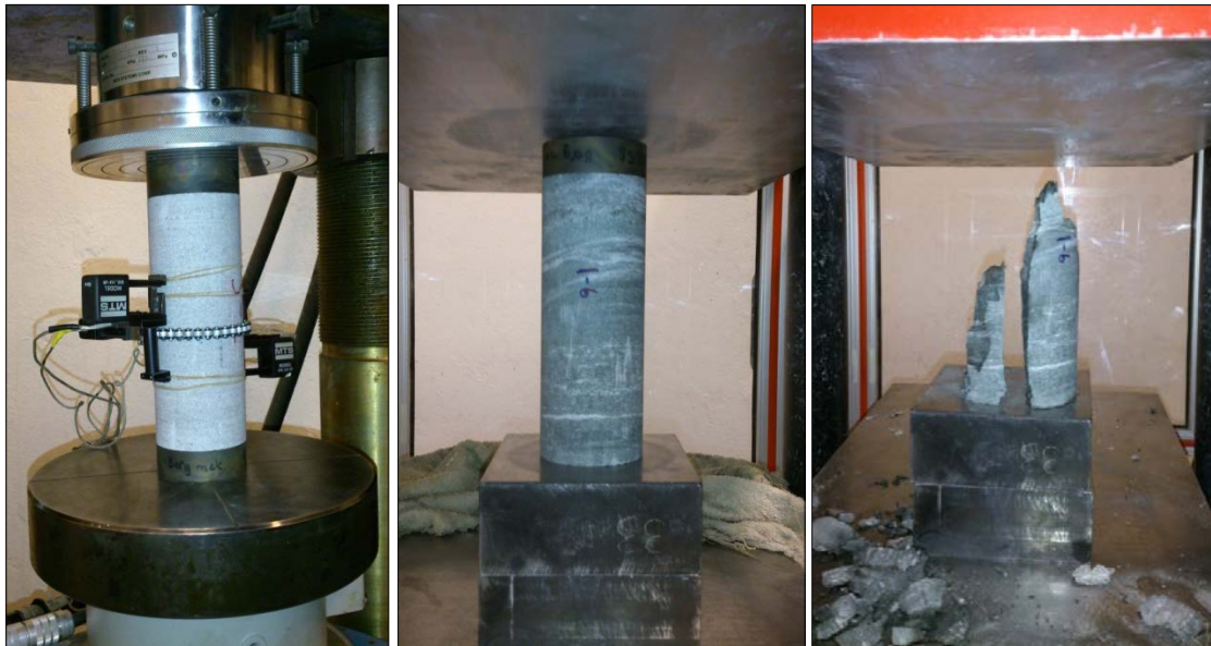
Figur 3.4. Venstre: måling av Young's modul og Poisson's forhold. Midten og høgre: UCS test, før og etter brot.
