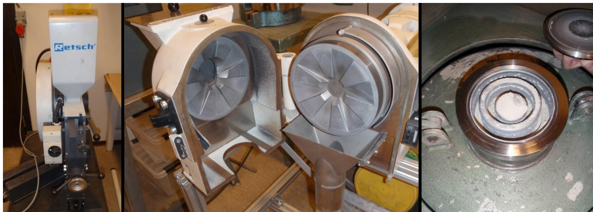
Figur 3.2 Nedknusingen ble foretatt i tre trinn. Fra venstre: kjefteknuser, skiveknuser og skivesvingmølle.
