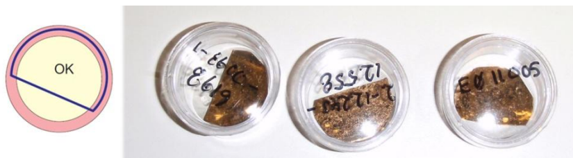
Figur 3.4 Skisse av prøvebeholder for svovelisotop analyse (diameter blått omriss ca. 20mm) (Nordsim hjemmeside, besøkt 30.11.12), og tre prøver ferdig preparert, klar for analyse.
