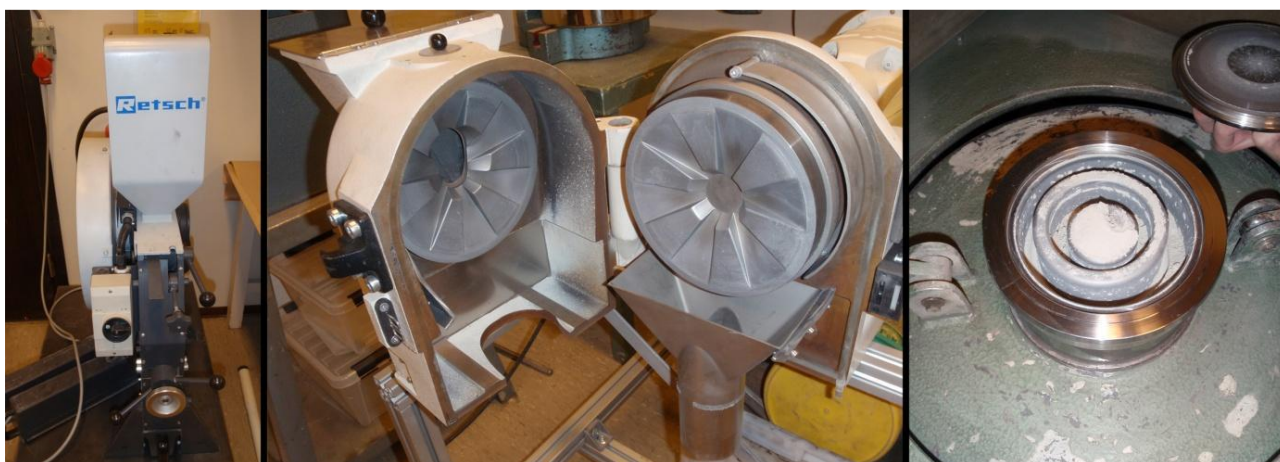
Figur 3.1: Knusemaskiner, fra venstre: Grovknuser, mellomknuser og finmaling. (Bilde: Endre Nerhus Øen)
