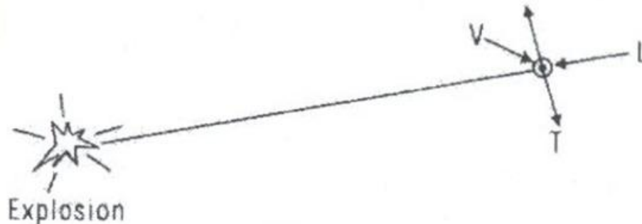
Figur 2-1: Tre vinkelrette komponenter av den seismiske bølgebevegelsen, vertikalt (V), longitudinalt (L) og transversalt (T) (Khandelwal, 2012).
