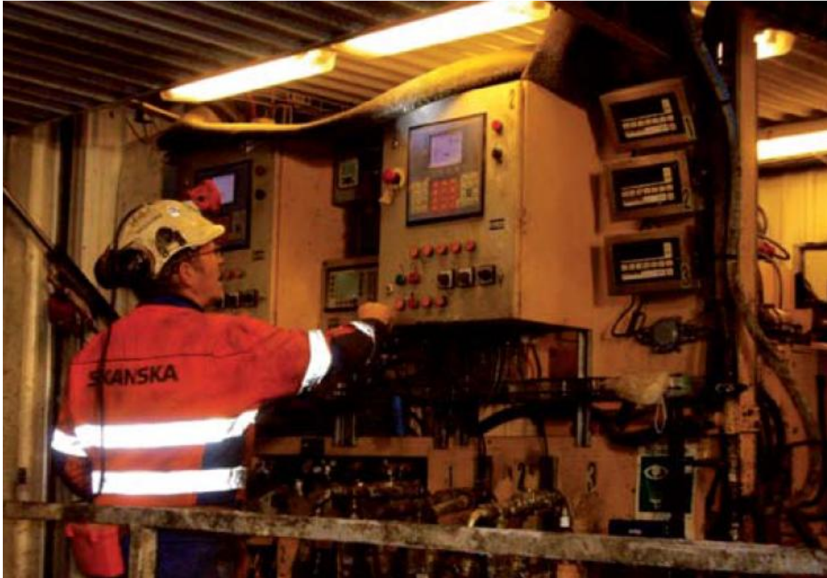
Figur 4: Figuren viser utstyret for datalogging på en moderne injeksjonsrigg (Fagermo, Frogner et al. 2008).
