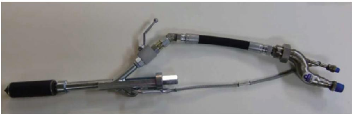
Figur 11: Figuren viser stav med munnstykke for akseleratortilsats koblet til. Staven er kort fordi dette er en demoversjon (Holter 2011).
