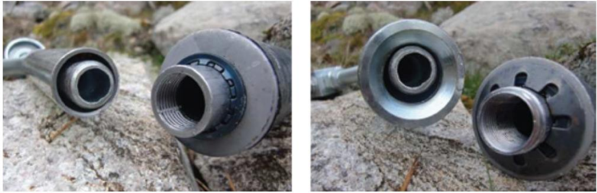
Figur 5: Pakkere med sete for mindre enn 60 bar (venstre), og mer enn 60 bar (høyre) (Kveen, Backer et al. 2010).
