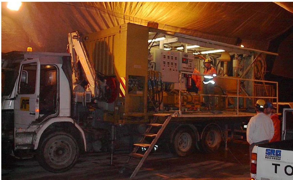
Figur 2: Figuren viser en typisk injeksjonsrigg brukt i norske tunneler (Syrjänen and Tolppanen 2003).
