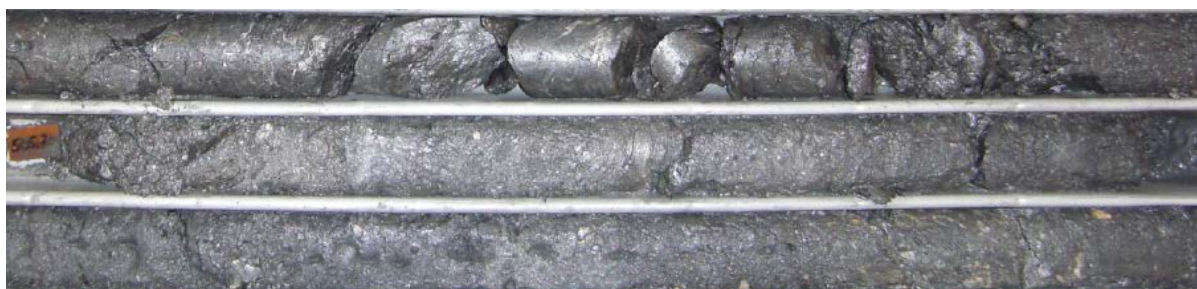
Figur 3-13 Hesteholmen ved ca. 506 m. Leirerik knusningssone, siltig til sandig breksjer (SVV, 2013b).
