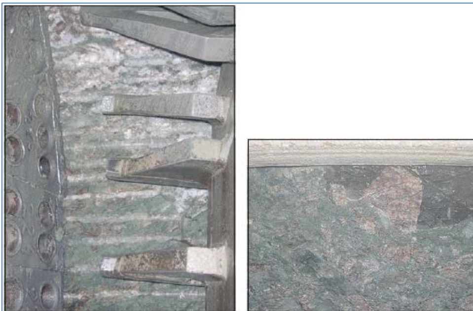
Figur 6-8 Helt forvitret gneis i frossen tilstand i MBZ(Sturk et. al., 2010).
