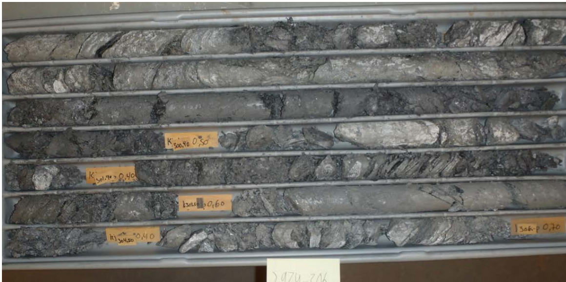
Figur 3-15 Krågøy Nord hull B (297 m – 306 m). Oppknust bergmasse og sleppematerialet (SVV, 2013b).
