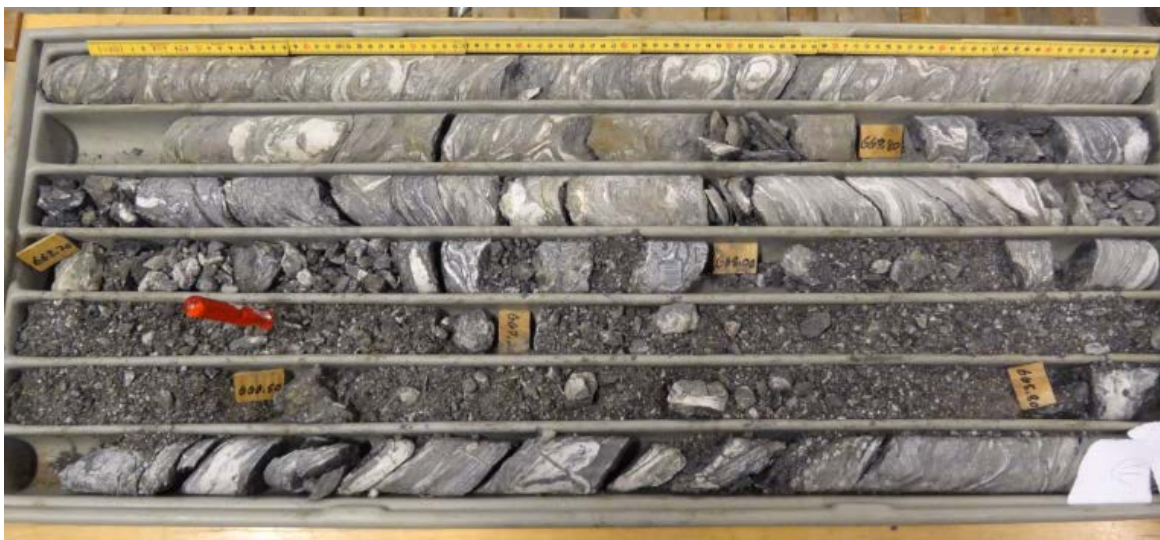
Figur 3-16 Sauholmen hull B (667 m – 674 m). Oppknust bergmasse, en seksjon med sand og grus, (Befaring, 2013)
