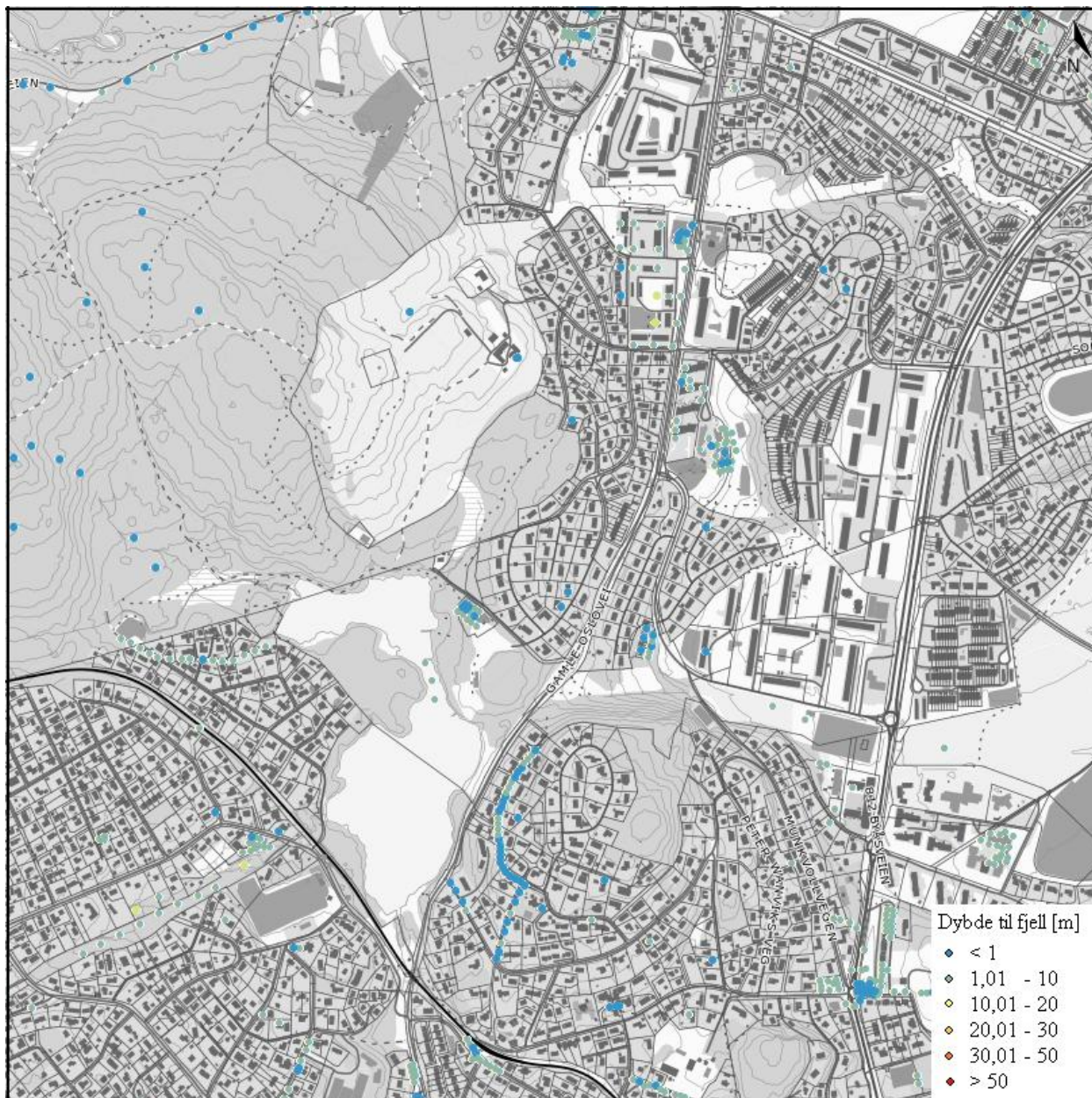
Figur i vedlegg C, 19. Kart for modell 1 angir punkter med dybde til fjell fra < 1 m til > 50 m. Kartutsnitt D2.
