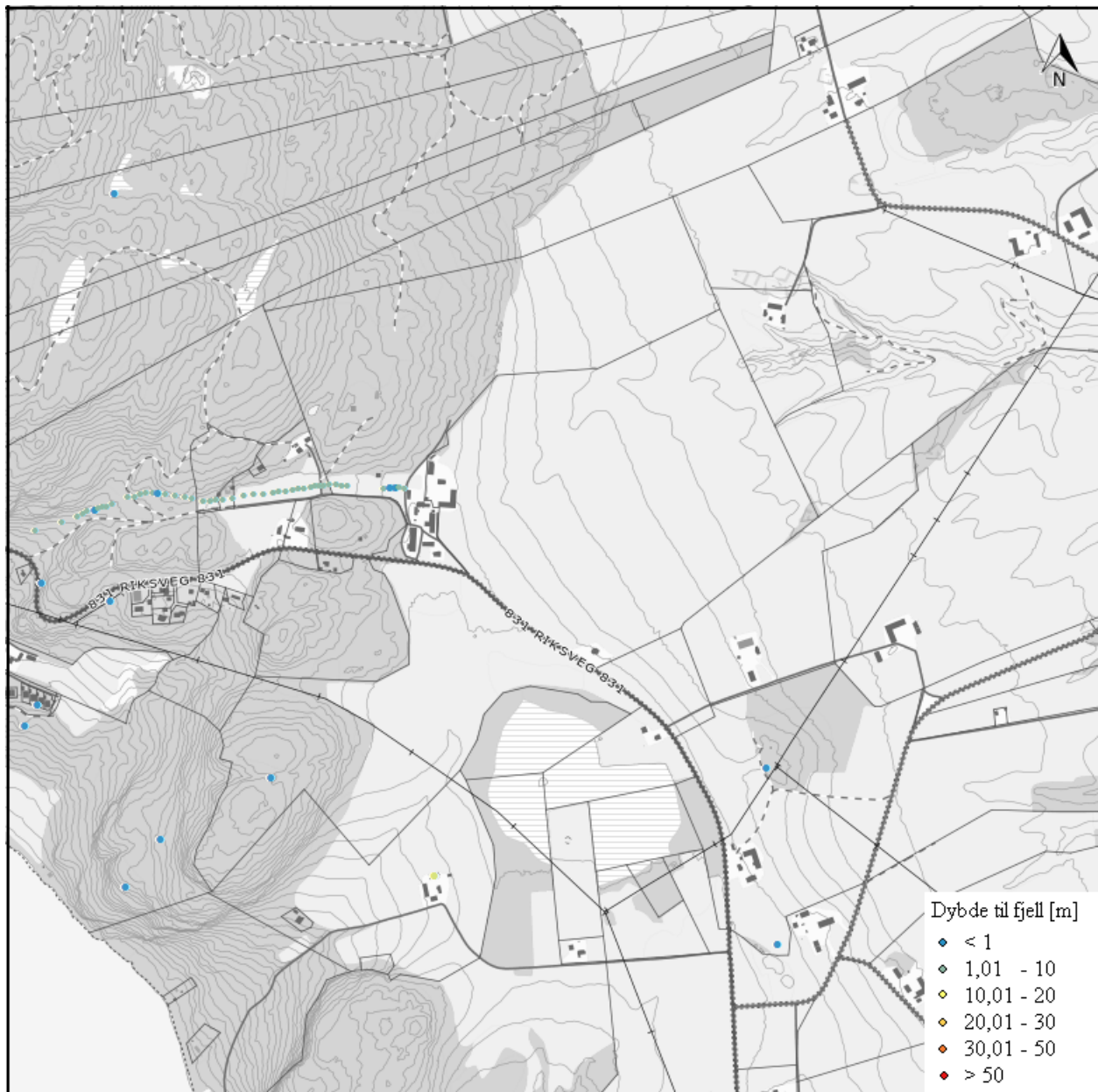
Figur i vedlegg C, 34. Kart for modell 1 angir punkter med dybde til fjell fra < 1 m til > 50 m. Kartutsnitt F1.
