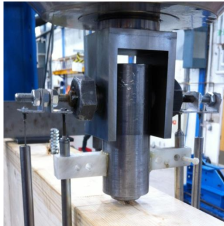
Figur 3.9 Kontroll av bevegelse mellom bolt og gripedel.
