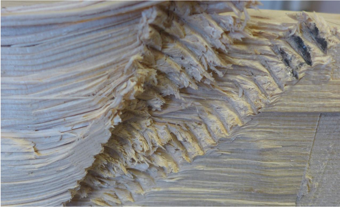
Figur 3.23 Delt prøve av forsøk med 45° vinkel, F10-45-1.
