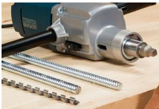
Figur 3.3 Bormaskin, borr og gjengestenger. Foto: SFS-intec [14].
