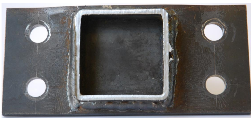
Figur 6. 9 Deformert endeplate. Figuren viser platens flytemønstre.
