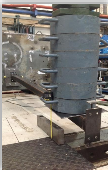
Figur 5. 6 Hele søylen montert og belastet om sterk akse.
