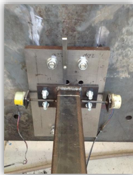
Figur 5. 4 Innfesting av endeplate til stiv bakplate, plassering av klinometre.
