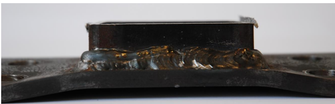
Figur 7. 19 Deformasjon ved belastning om svak akse. Geometri 1.
