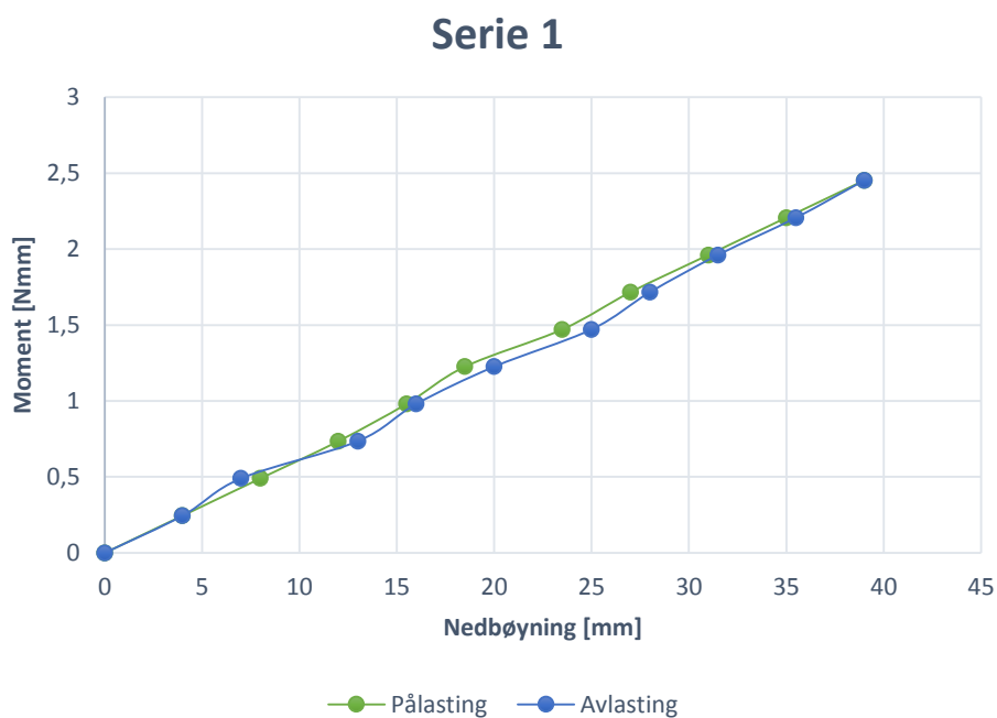
Figur C.1. 5 Nedbøyningskontroll serie 1 Geometri 1, Svak akse.
