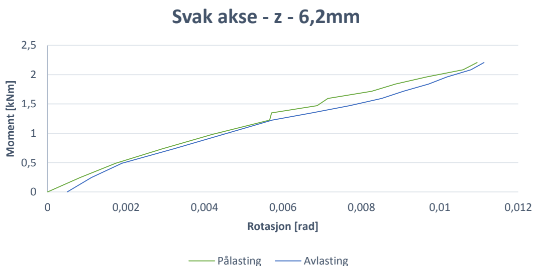
Figur 6. 3 Stivhetsrelasjon for forsøksserier. Geometri 2, svak akse
