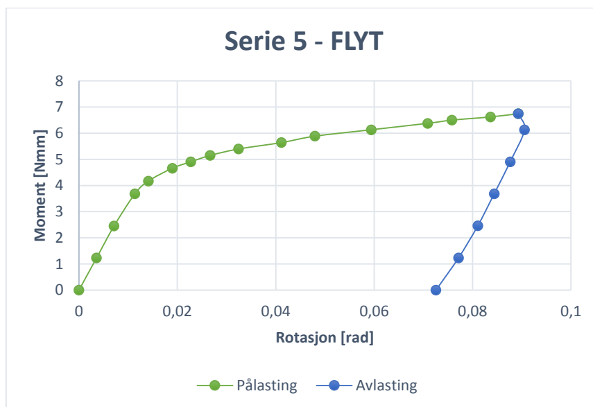
Figur C.5. 1 Stivhetsrelasjon Plastisk. Geometri 1, Svak akse.
