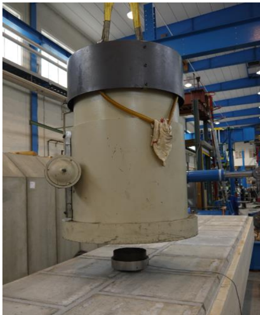
Figur E.6 Plassering av vekt på lastmåler under lastsituasjon 3
