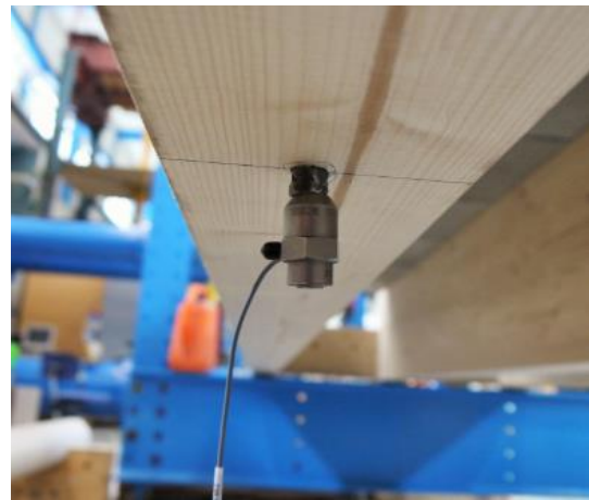
Figur 5.25 Akselerometer ved plassering under bjelke C
