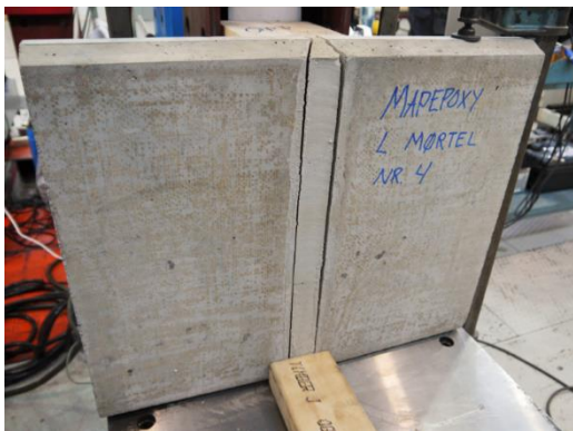
Figur 5.15 Mapepoxy L-Mørtel nr. 4, brudd i fugemørtel
