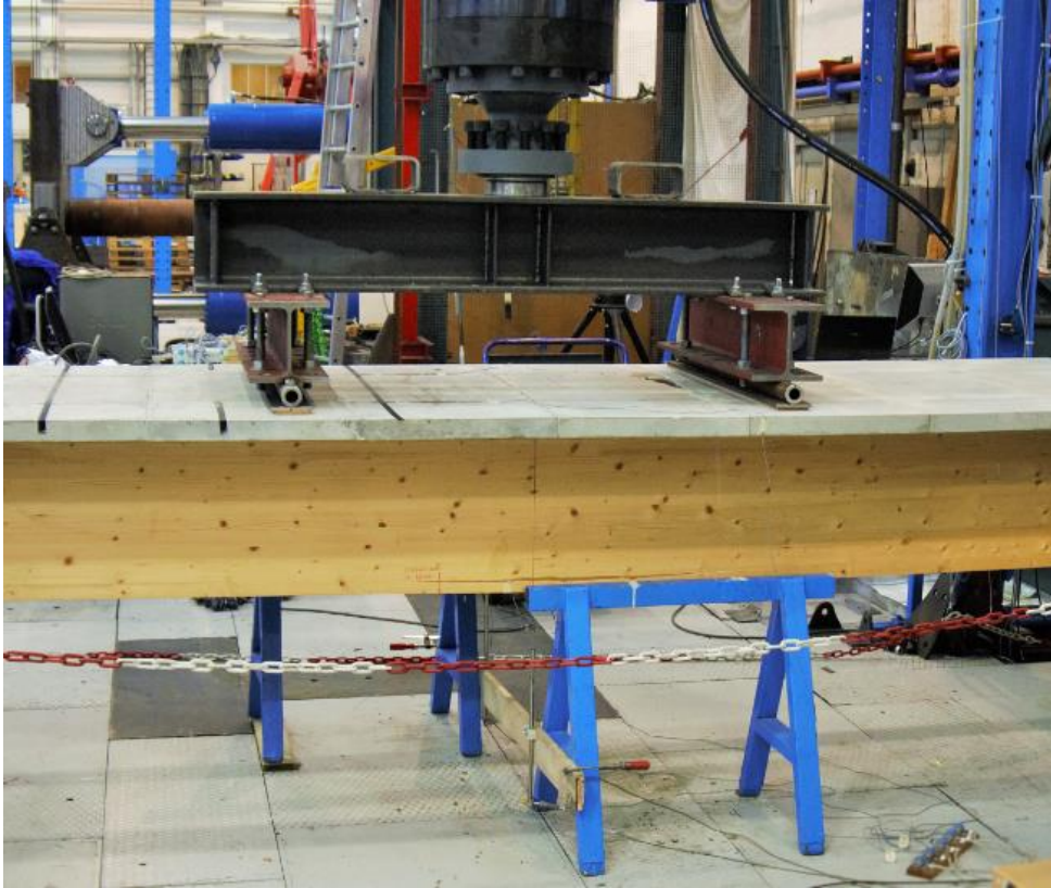
Figur 5.2 Lastfordeler og strekkbrudd i limtrebjelke A
