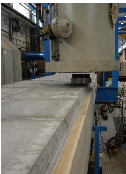
Figur E.4 Plassering av last og detalj av lastmåler
