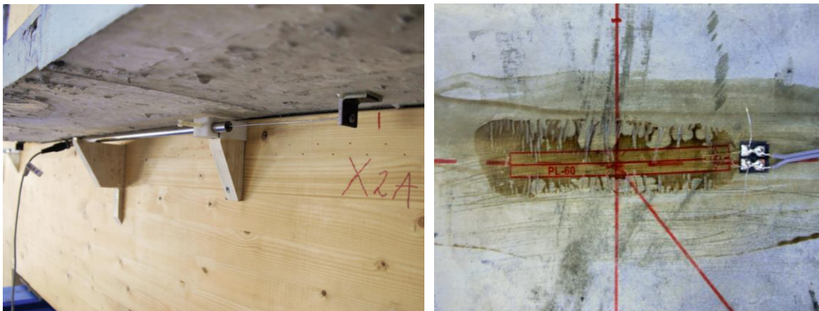
Figur C.2 Høyre: Måleinstrument X2A, Venstre: Tøyningmåler på betong
