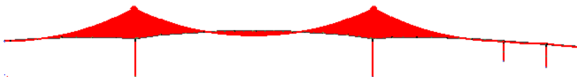
Figur 5.11 Momentdiagram fra lasttilfellet <konstruksjonens tyngde>
