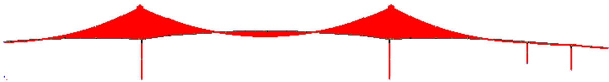
Figur 4.9 Momentdiagram for egenlast og trafikklast fra Focus
