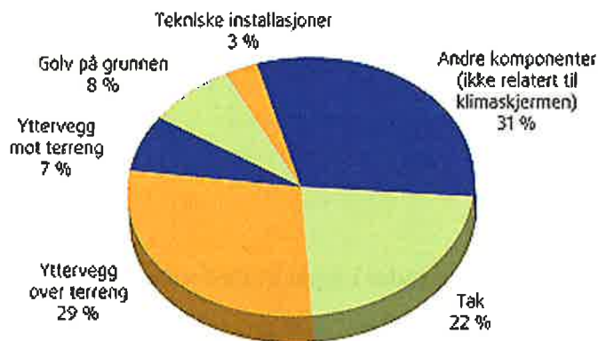
Figur 10: Prosessforårsakede byggskader 1993–2002 fordelt på skadested, byggdetaljblad 700.110
