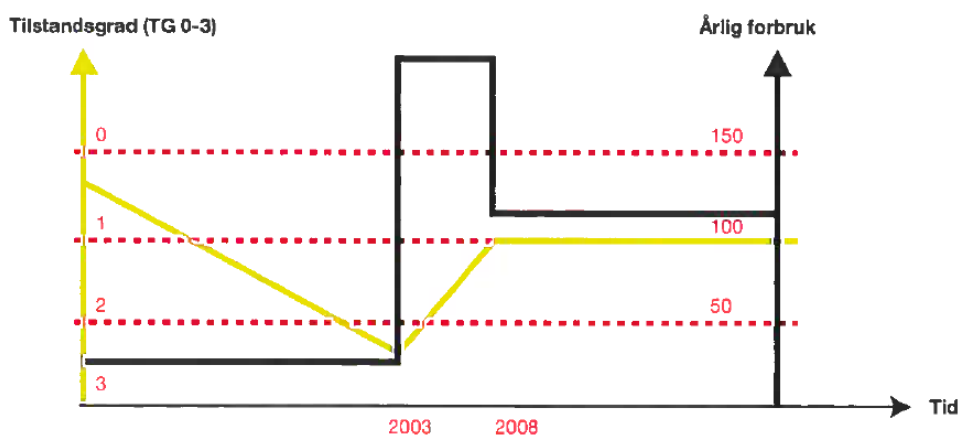
Figur 24: Sammenheng mellom økning i gjennomsnittlig tilstandsgrad over tid og konstant økonomisk kostnadsløft over en femårsperiode, for så å normalisere vedlikeholdet
