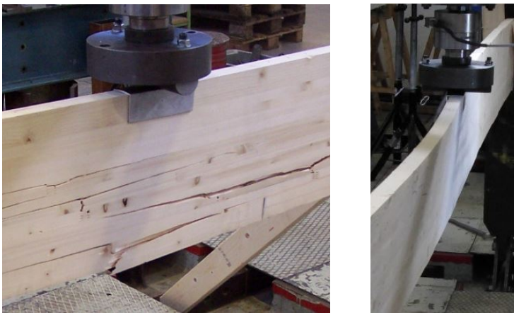
Figur 4.11: Strekkbrudd og utbøyning for bjelker uten utsparing fra B-serien utført av Degro [8].
