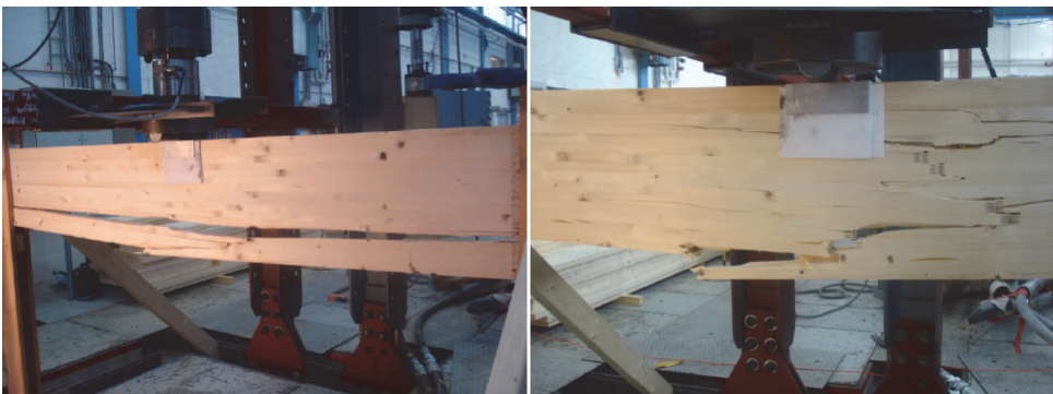
Figur 4.13: Strekkbrudd for BVS-170 serien utført av Solberg [17].
