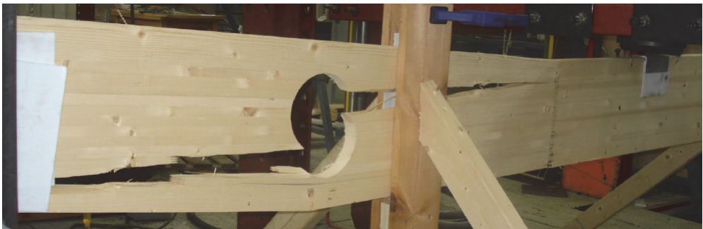
Figur 4.12: Kollaps i skjær-dominert sone som følge av at sprekken får vokse fritt fra BV170-serien utført av Solberg [17].
