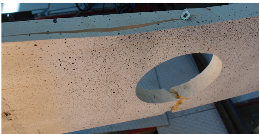
Figur 4.16: Kollaps pga strekk underkant som følge av utbøyning i overkant fra BMS170,30-serien utført av Solberg [17].
