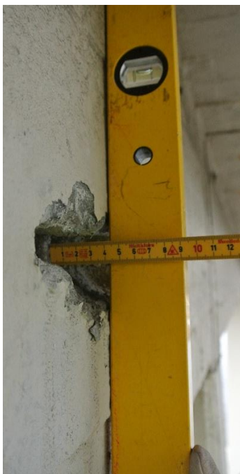
Figur 10.13 Manuell måling Figur 10.14 Måling av overdekning med covermeter
