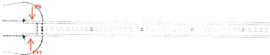
Figur 10.35 Plassering av prøver i landkar, P9 og P11
