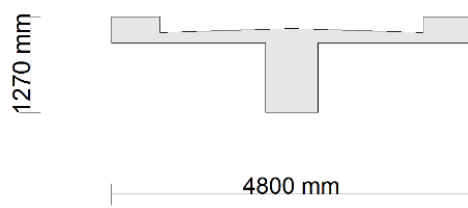
Figur 4.12 tverrsnitt for akse 5-9 og 12-16
