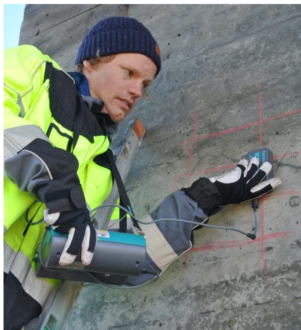
Figur 10.13 Manuell måling Figur 10.14 Måling av overdekning med covermeter
