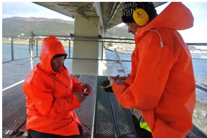
Figur 10.17 Merking av kloridprøver og rengjøring av utstyr
