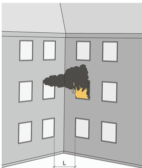
Figur 3.3: Brannspredning i innvendig hjørne (SINTEF Byggforsk 2006).
